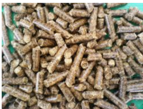
Εικόνα 2.27 : Μια μορφή βιομάζας: pellets (συσσωματώματα) τα οποία προκύπτουν από τη μηχανική συμπίεση πριονιδιού, χωρίς την προσθήκη χημικών ή συγκολλητικών ουσιών, http://el.wikipedia.org/
