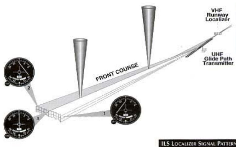
Εικόνα 42. Η λειτουργία του υποσυστήματος ILS Localizer
