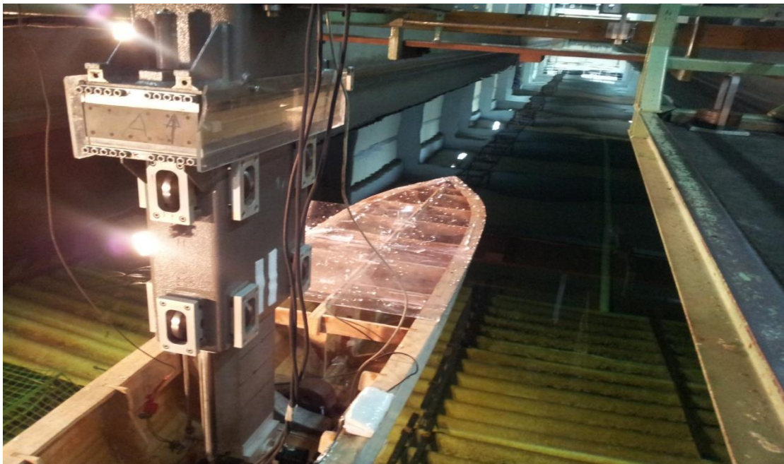
Εικόνα 4.9. Το μοντέλο συνδεδεμένο με το δυναμόμετρο.
