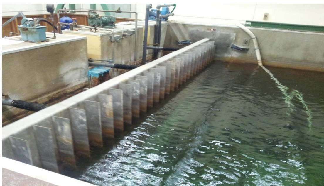
Εικόνα 4.10. Πλάνο του κυματιστήρα όπου διακρίνονται και τα έμβολα κίνησης του.
