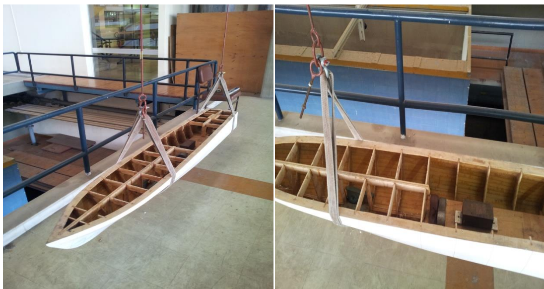
Εικόνες 4.3-4.4. Διακρίνεται η πρόσδεση του μοντέλου στους μιάντες, καθώς και κάποια από τα μετακινήσιμα βάρη.
