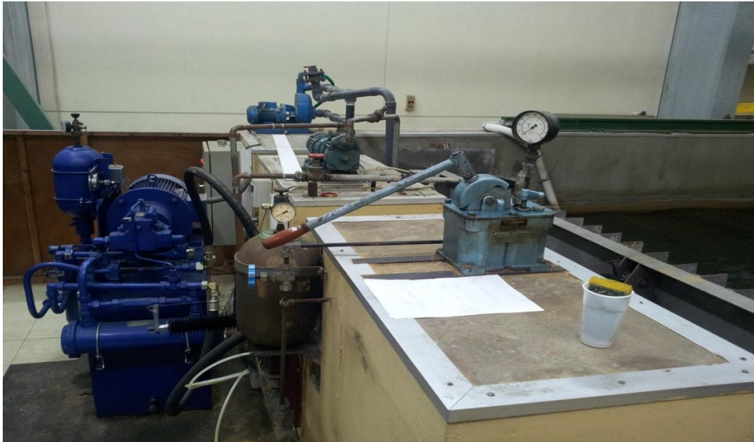
Εικόνα 4.11. Πλάνο του σερβοκινητήρα που κινεί το έμβολο του κυματιστήρα.
