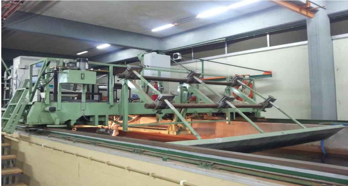
Εικόνα 4.2. Το φορείο της Πειραματικής Δεξαμενής. Διακρίνεται στο πίσω μέρος ο αποσβεστήρας.
