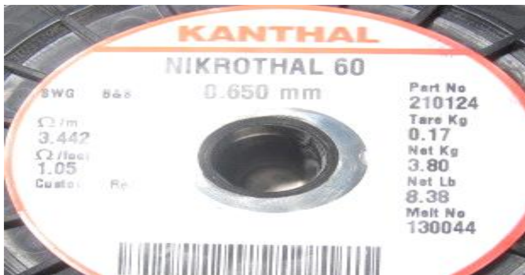
Εικόνα 1 Ρολό χρωμονικελίνης. Αριστερά και δεξιά της ετικέτας αναγράφονται τα μηχανικά χαρακτηριστικά και οι κωδικοί παραγωγής
