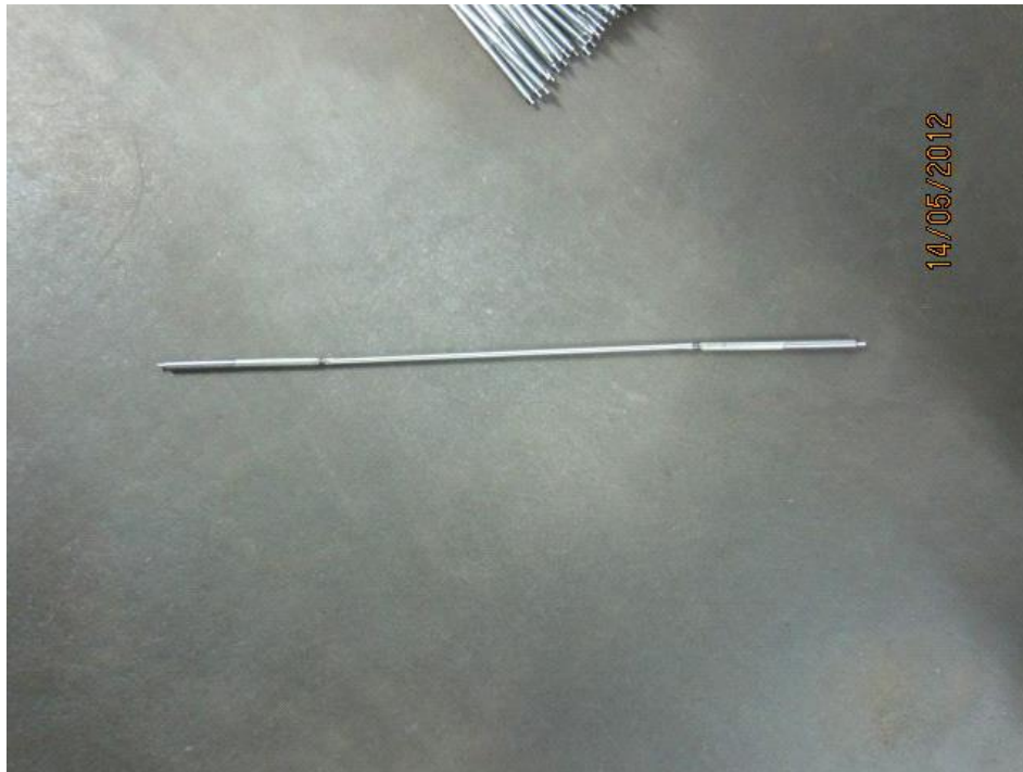
Εικόνα 14 Το ελατήριο μετά την συγκόλληση του με τους ακροδέκτες
