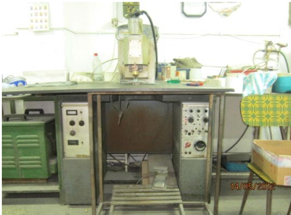
Εικόνα 15 Ηλεκτροπόντα συγκόλλησης ελατηρίου - ακροδέκτη
