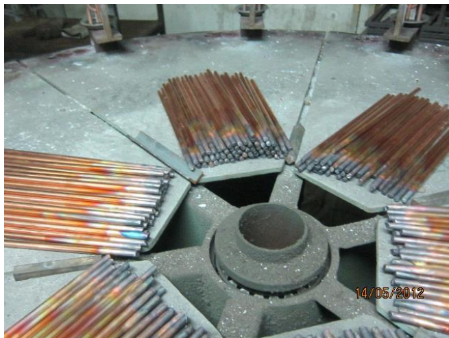
Εικόνα 27 Σφραγισμένοι σωλήνας στο άνω άκρο έτοιμος για συγκόλληση
