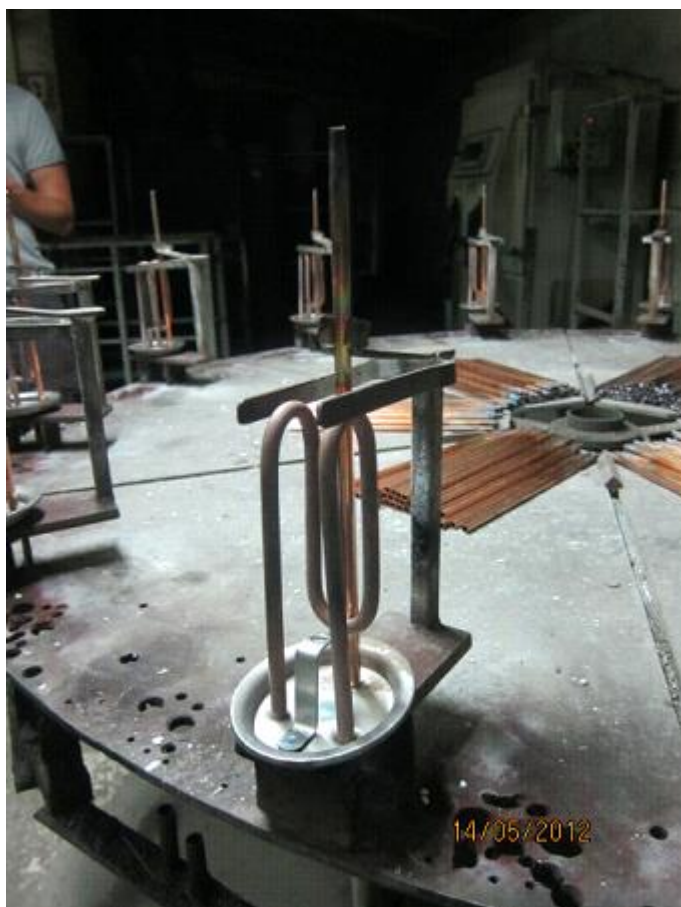
Εικόνα 30 Οβάλ αντίσταση στην βάση συγκόλλησης
