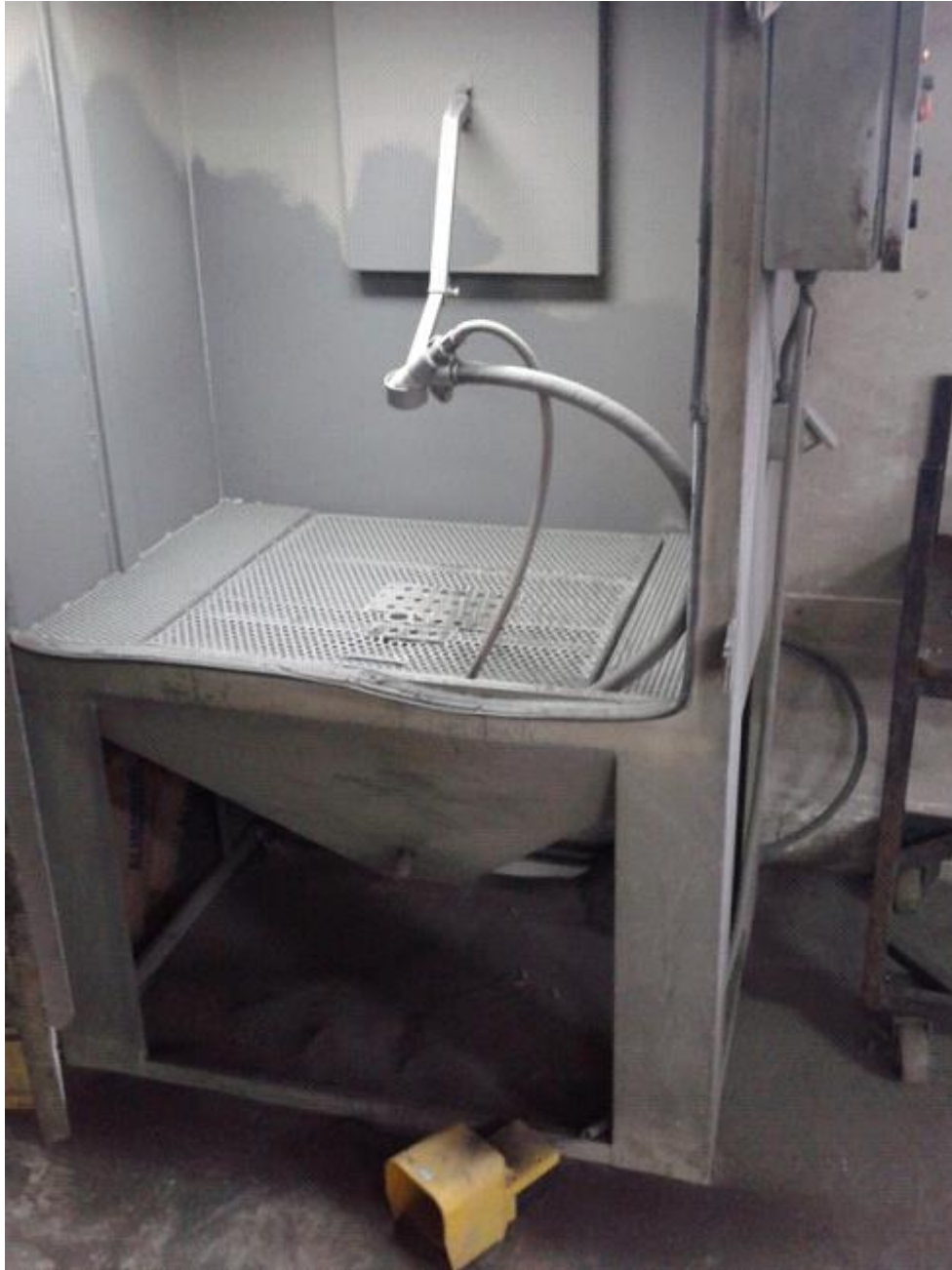
Εικόνα 25 Θάλαμος αμμοβολής. Διακρίνεται ο σωλήνας και η λάβει της δέσμης συμπιεσμένου αέρα και λεπτόκοκκης άμμου.
