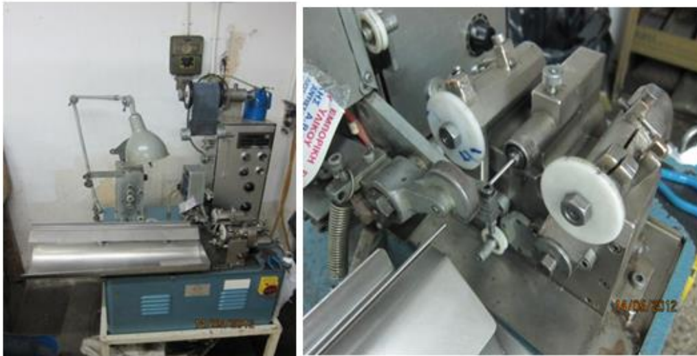
Εικόνα 12 Αριστερά: Μηχανή ελατηριοποίησης Δεξιά: κεφαλή της μηχανής με τα ράουλα και το ελατήριο
