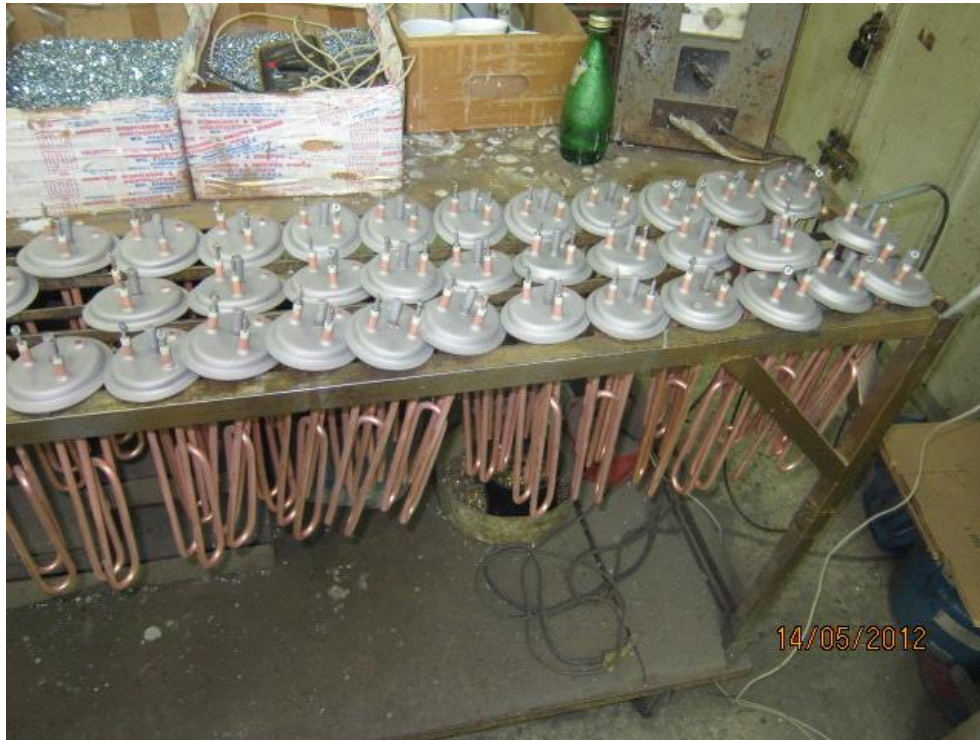
Εικόνα 33 Σφραγισμένες αντιστάσεις πριν την επιψευδαργύρωση
