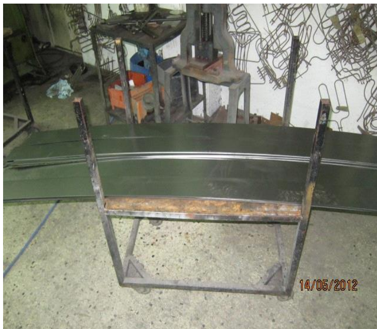
Εικόνα 4 Κομμένα ελάσματα χάλυβα σε φύλλα 2m x 150mm πριν την χρήση σε πρέσα
