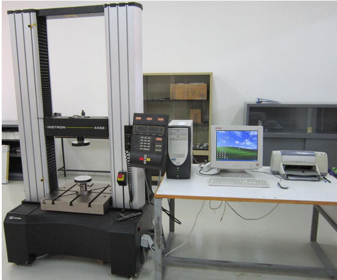
Σχήμα 6 Συνολική Διάταξη Πρέσας INSTRON του εργαστηρίου
