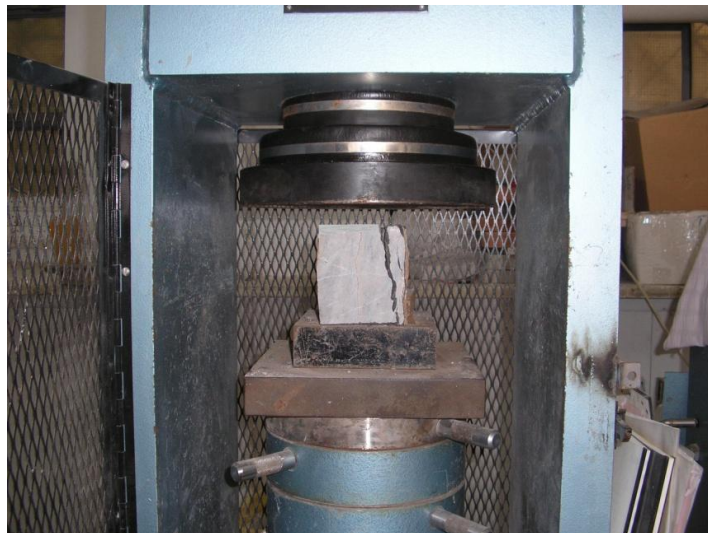
Σχ. 4.2.4 Μηχάνημα επιβολής θλιπτικής δύναμης
