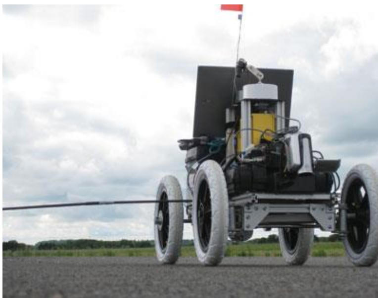
Εικόνα 2.16: 3D σύστημα προφίλομέτρησης RoboTex (Rasmussen, 2013)
