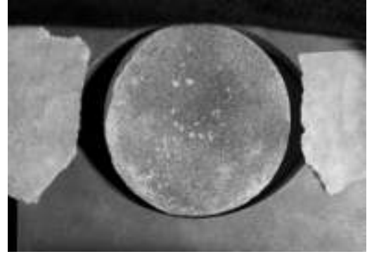
Εικόνα 79 Δοκιμή Brazilian με μοτίβο από ματ σπρέι όπου έχουν καλυφθεί οι γυαλιστερές επιφάνειες για να μην δημιουργούν προβλήματα στην φωτεινότητα
