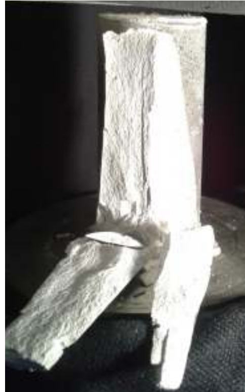
Εικόνα 16 Αστοχία κυλινδρικού δοκιμίου γύψου σε θλίψη (αξονικός σχισμό σε θλίψης)
