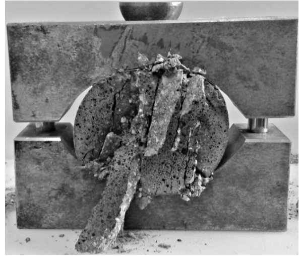
Εικόνα 13 Αστοχία δοκίμιου τσιμεντοκονιάματος σε εφελκυσμό (Brazilian test)
