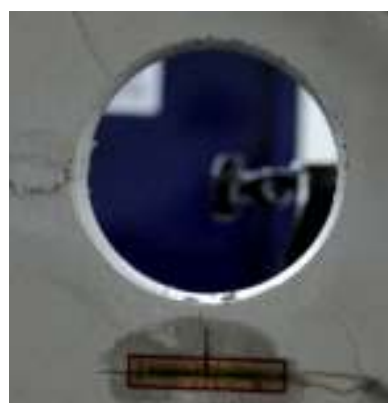
Εικόνα 87 Θέση τοποθέτησης του strain gauge στο δοκίμιο 8
