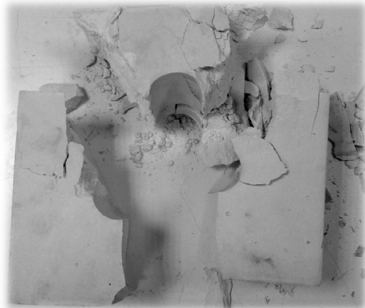
Εικόνα 29 Γενική εικόνα του δοκιμίου μετά τη θραύση όπου φαίνονται οι ρωγμές διάτμησης με κλίση 70°
