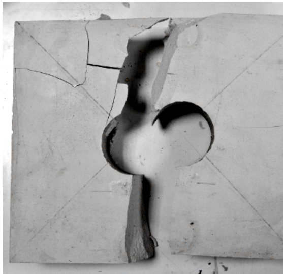
Εικόνα 38 Γενική μορφή θραύσης του δοκιμίου 7
