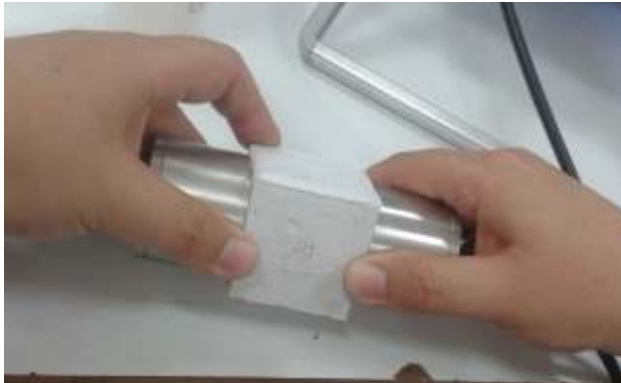
7.α. Δοκιμή υπερήχων στο δοκίμιο Δ1
