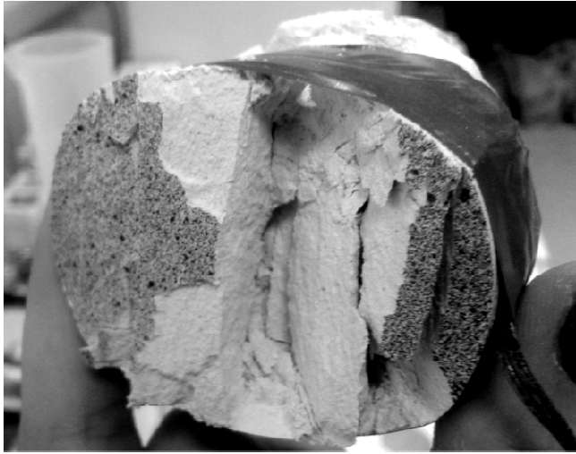
Εικόνα 12 Αστοχία γύψινου δοκίμιου σε εφελκυσμό (Brazilian test)
