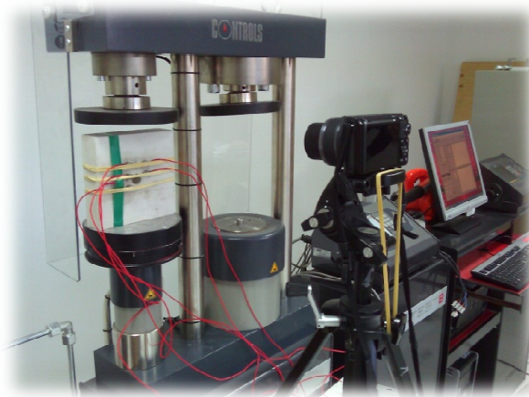
Εικόνα 1 Τοποθέτηση του δοκιμίου 1 στο πλαίσιο θλίψης
