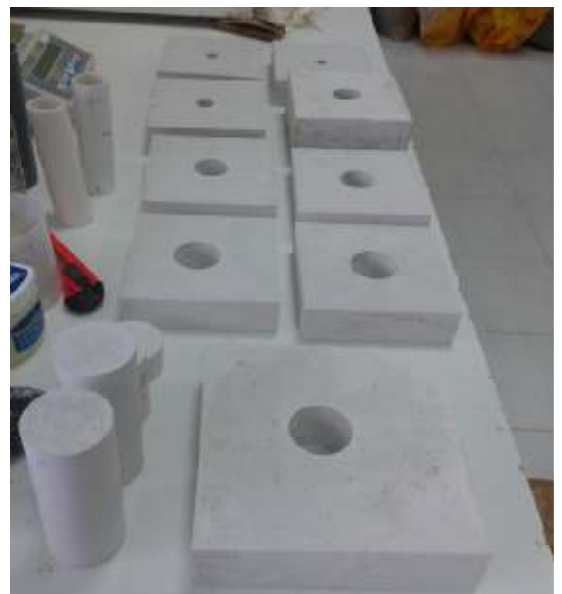
Εικόνα 9 Δοκίμια γύψου με διαφόρων διαστάσεων οπές
