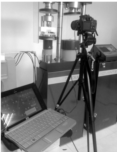
Εικόνα 20 Προετοιμασία για τη δοκιμή κάμψης με ταυτόχρονη δοκιμή μέτρησης της παραμόρφωσης μέσω συσχέτισης ψηφιακών εικόνων (DIC)
