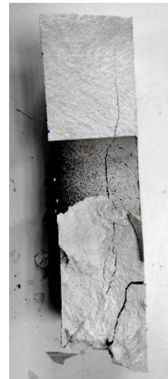
Εικόνα 39 Η εφελκυστική ρωγμή παράλληλα στο μέτωπο του δοκιμίου
