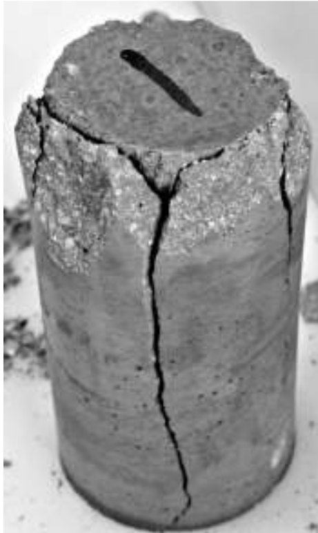
Εικόνα 15 Αστοχία δοκιμίου τσιμεντοκονιάματος σε θλίψη (αξονικός σχισμός σε θλίψη)
