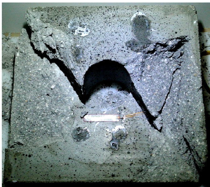
Εικόνα 68.1: Δοκίμιο grout 5 μετά την επαναφόρτιση
