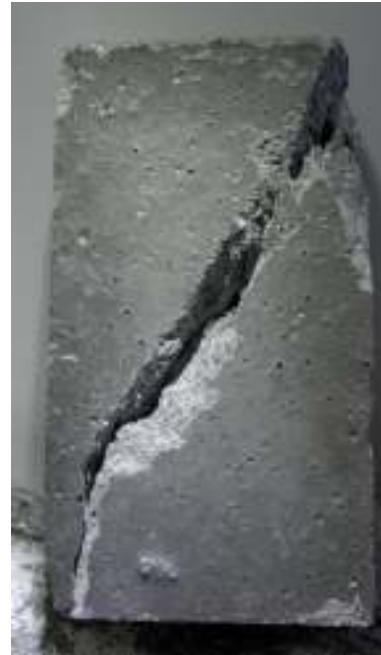
Εικόνα 19 Αστοχία σε θλίψη πρισματικού δοκιμίου από τσιμεντοκονίαμα
