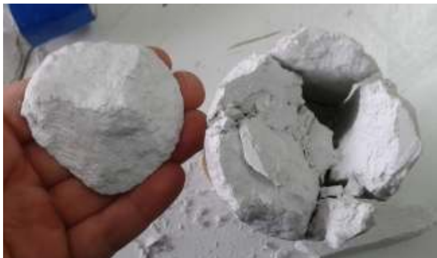
Εικόνα 17 Διατμητική θραύση κοντά στο άκρο του κυλινδρικού γύψινου δοκιμίου που αστόχησε σε θλίψη με αξονικό σχισμό. Το ίδιο συνέβη και στο δοκίμιο τσιμεντοκονιάματος.
