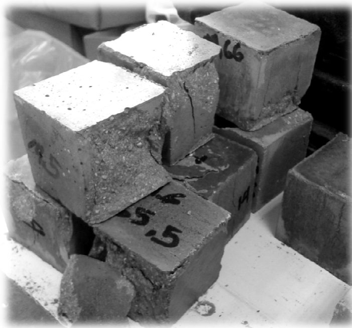
Εικόνα 10 Αστοχία σε θλίψη κυβικών δοκιμίων τσιμεντοκονιάματος
