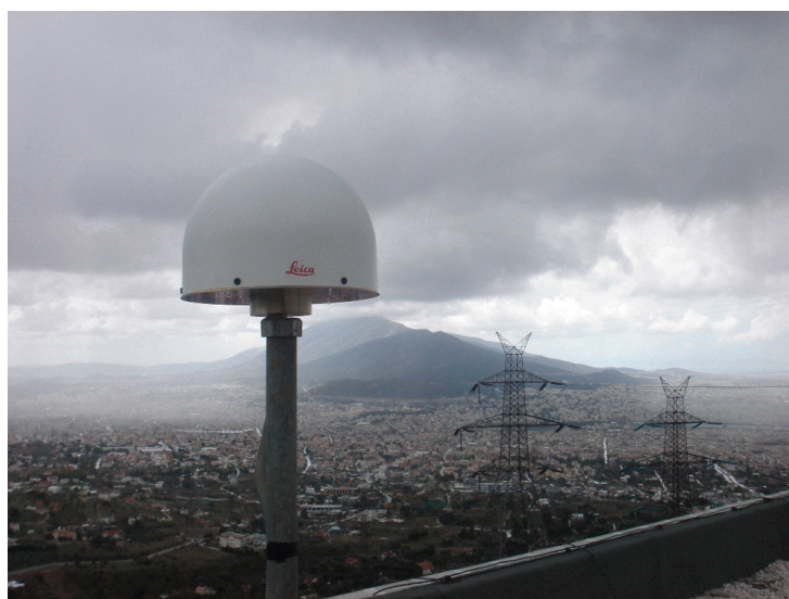
Σχήμα 5.3: Μόνιμος γεωδαιτικός σταθμός NOA (EUREF) Figure 5.3: Permanent Geodetic Station NOA (EUREF)
