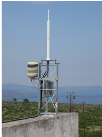
Σχήμα 3.3: Το σύστημα DORIS στο σταθμό του Διονύσου από το 1989 – σήμερα
