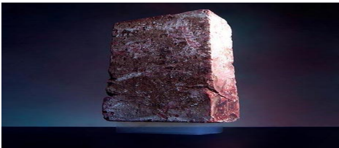
Εικ. 17. Στοιχείο από αεροτζέλ πυριτίου βάρους 2 γραμμαρίων υποβαστάζει άνετα ένα συμπαγές τούβλο βάρους 2.5 κιλών. [37]
