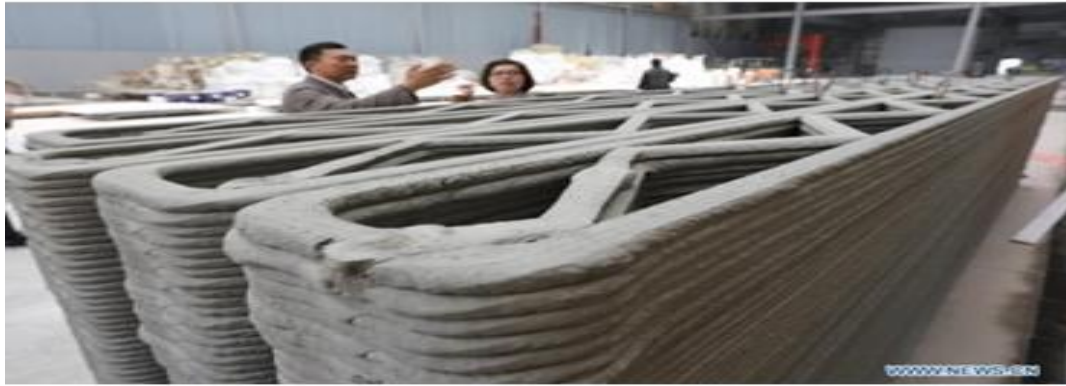
Εικ. 22. Προκατασκευασμένα στοιχεία μέσω τρισδιάστατου εκτυπωτή, Κίνα.[67]
