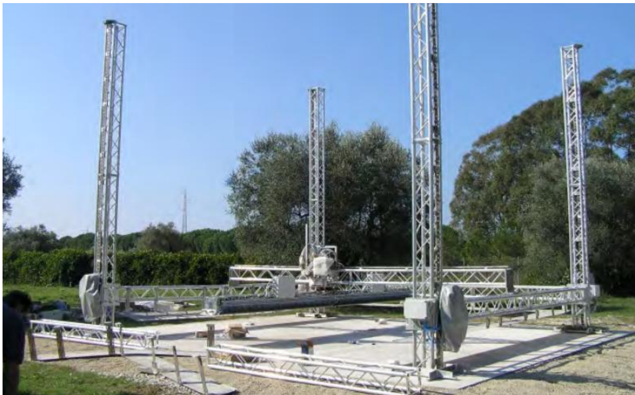
Εικ. 25. Ένας από τους μεγαλύτερους τρισδιάστατους εκτυπωτές του Enrico Dini.[73]
