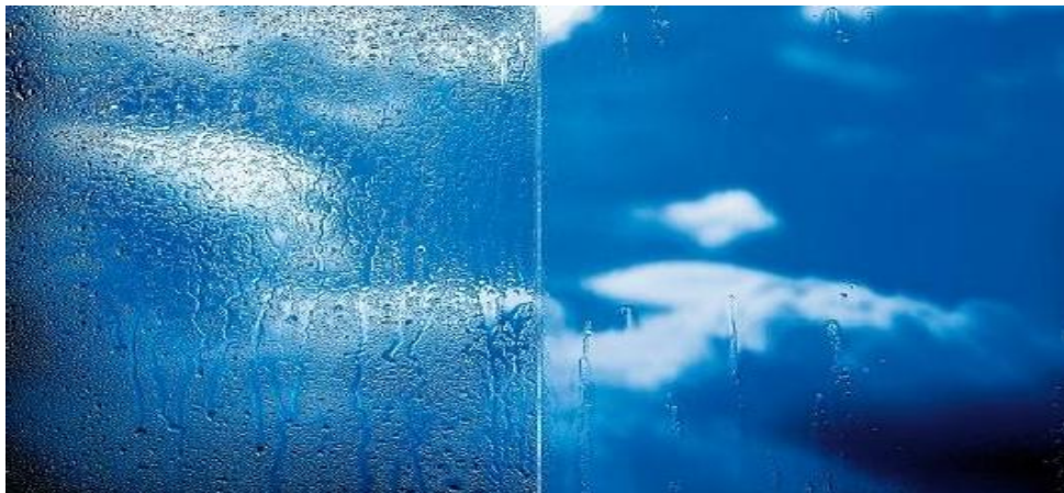
Εικ. 2. Ο αυτοκαθαριζόμενος υαλοπίνακας με επικάλυψη διοξειδίου του τιτανίου[11]
