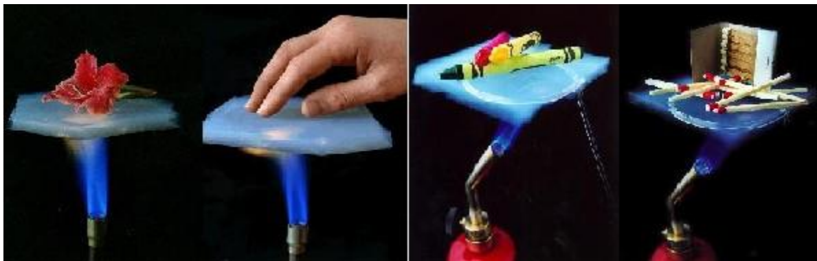
Εικ. 16. Υψηλός βαθμός πυροπροστασίας λεπτού στρώματος 'αεροτζέλ'. [36]
