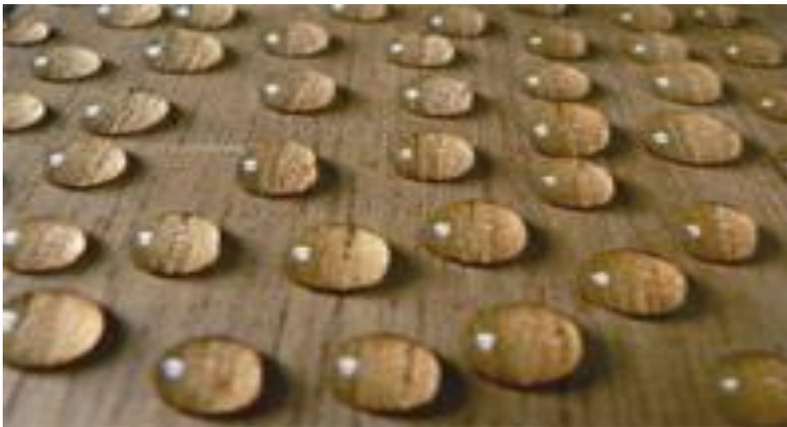
Εικ. 5. Νανοτεχνολογία για απορροφητικές ξύλινες επιφάνειες με απλή εφαρμογή.[16]
