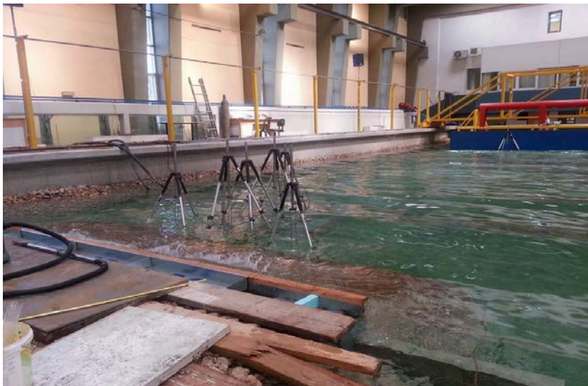
Φωτ.3.4 Μετρητές κατά την διάρκεια εκτέλεσης πειραματικών μετρήσεων
