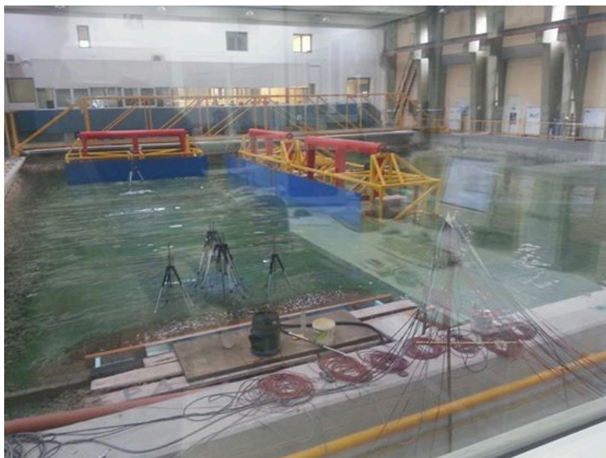
Φωτ.3.3 Συστήματα παραγωγής κυμάτων
