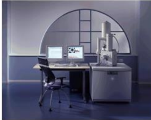
Εικόνα 5. 1: Ηλεκτρονικό μικροσκόπιο σάρωσης (Fei Co, The Netherlands.)
