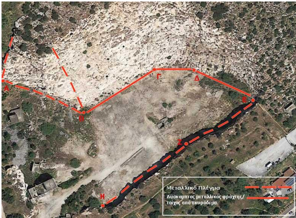
Σχήμα 8.1 Συγκεντρωτική απεικόνιση προτεινόμενων μέτρων προστασίας ανα τμήμα στο λατομείο Βλάχου
