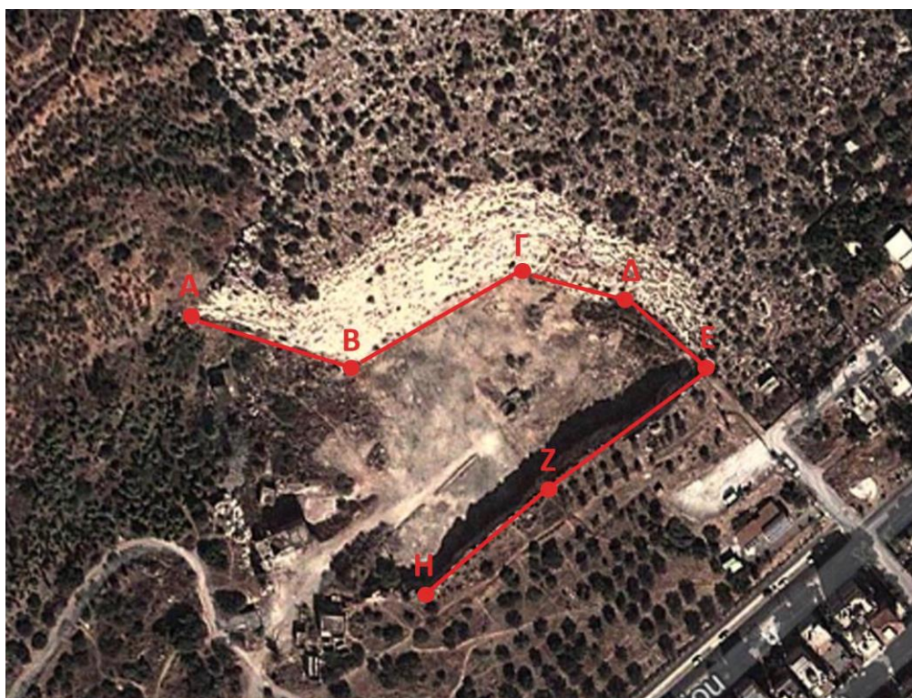
Σχήμα 5.1 Επιμέρους τμήματα πρανών λατομείου Βλάχου όπως ορίστηκαν για τις ανάγκες της μελέτης
