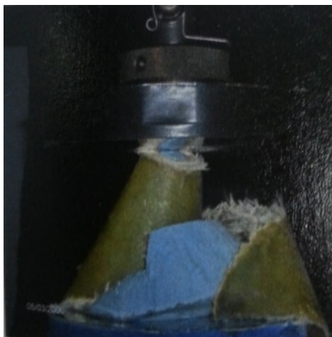
Σχήμα 5.64: Συγκριτικές εικόνες συμπίεσης δοκιμίου σε προσομοίωση και σε πείραμα
