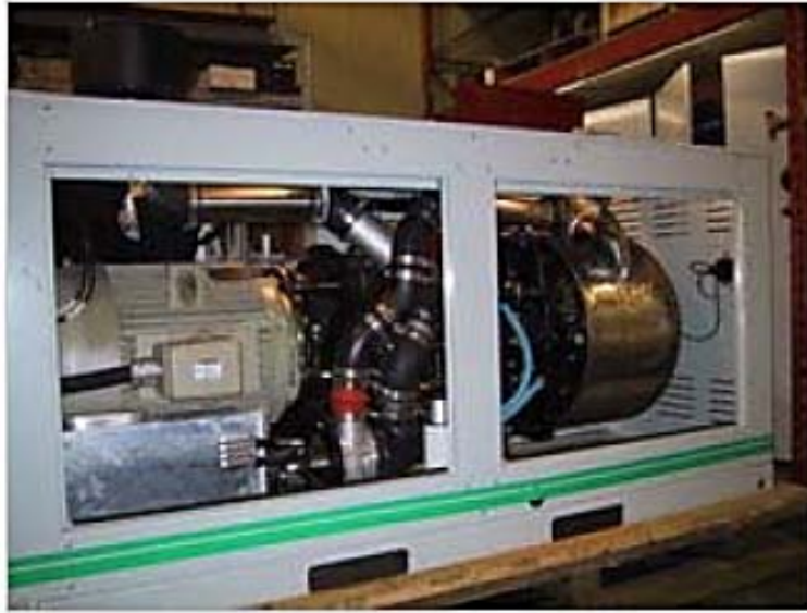
Εικόνα 2.3: Μηχανή συμπαραγωγής Stirling και γεννήτρια με ηλεκτρική ισχύ 55 kW (29. Ιστοσελίδα: www.stirlingenergy.com )
