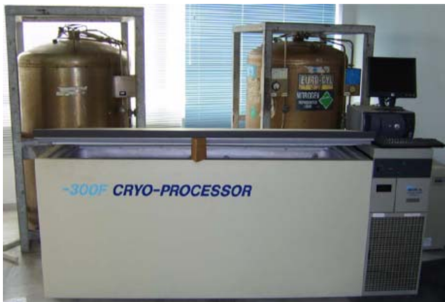
Εικόνα 3.12: Εργαστηριακή διάταξη κρυογονικής κατεργασίας μετάλλων (37. Darwin)
