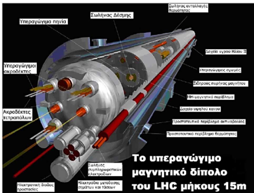
Εικόνα 3.2: Λεπτομερής ανάλυση του υπεραγωγίου διπόλου, βασικού στοιχείου του επιταχυντή LHC, μαζί με το κρυογονικό σύστημα για την λειτουργία του σε εξαιρετικά χαμηλή θερμοκρασία περίπου 1,9 K (41. Gazis E.)
