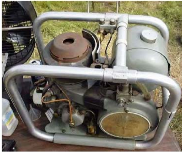
Εικόνα 2.5: Ηλεκτρική γεννήτρια της Philips (19. Hargreaves C.M.)
