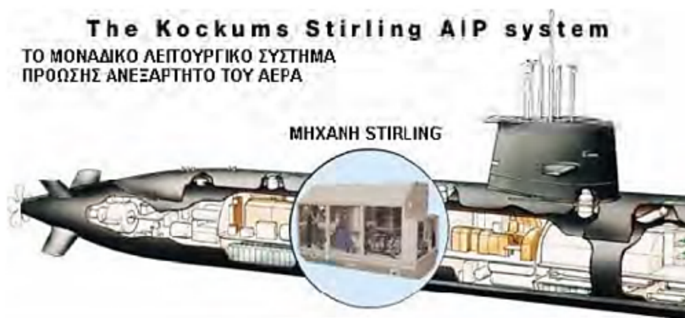
Εικόνα 2.16: Σύγχρονο Σουηδικό υποβρύχιο κινούμενο με μηχανή Stirling (21. Hirata K.)
