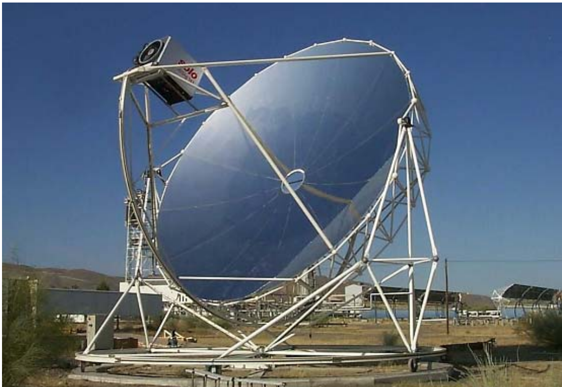
Εικόνα 2.32: Σύστημα δίσκου/μηχανής Stirling (23. Moreno J.)
