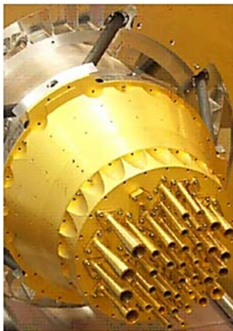
Εικόνα 3.6: Τμήμα της κρυογονικής δεξαμενής του δορυφόρου Herschel (52. Ιστοσελίδα: www.airliquide.com )
