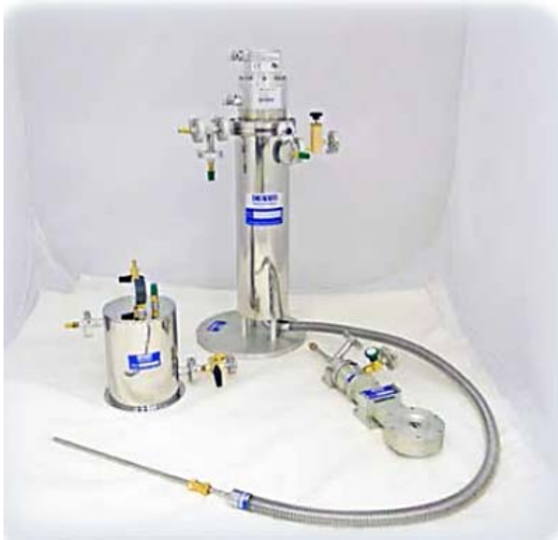
Εικόνα 3.4: Κρυογονική συσκευή CRYOCOOL-G2b (20K) με μικροσκόπιο (36. Cryo Industries of America Inc.)
