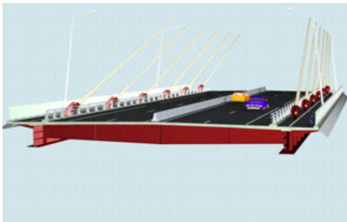
Στοιχείο του καταστρώματος.
