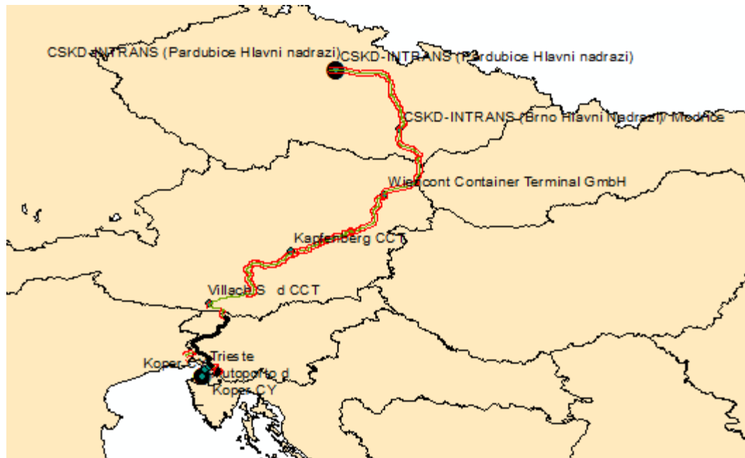
Εικόνα 45: Διαδρομή Κόπερ-Παρντουμπίτσα. Με μαύρο χρώμα φαίνεται το τμήμα της διαδρομής στο οποίο η σιδ. γραμμή δεν ηλεκτροδοτείται
