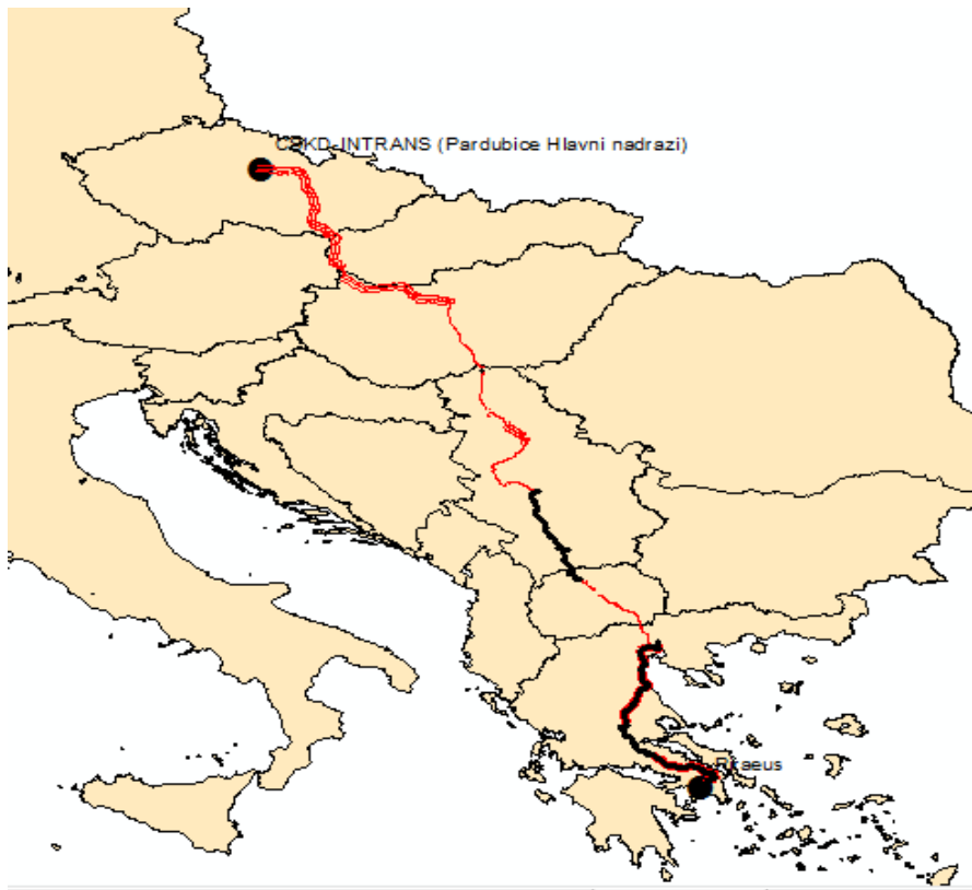
Εικόνα 36: Πειραιάς-Παρντουμπίτσα ελάχιστη χιλιομετρικά διαδρομή. Με μαύρο χρώμα διακρίνονται τα τμήματα της σιδ. γραμμής που δεν ηλεκτροδοτούνται
