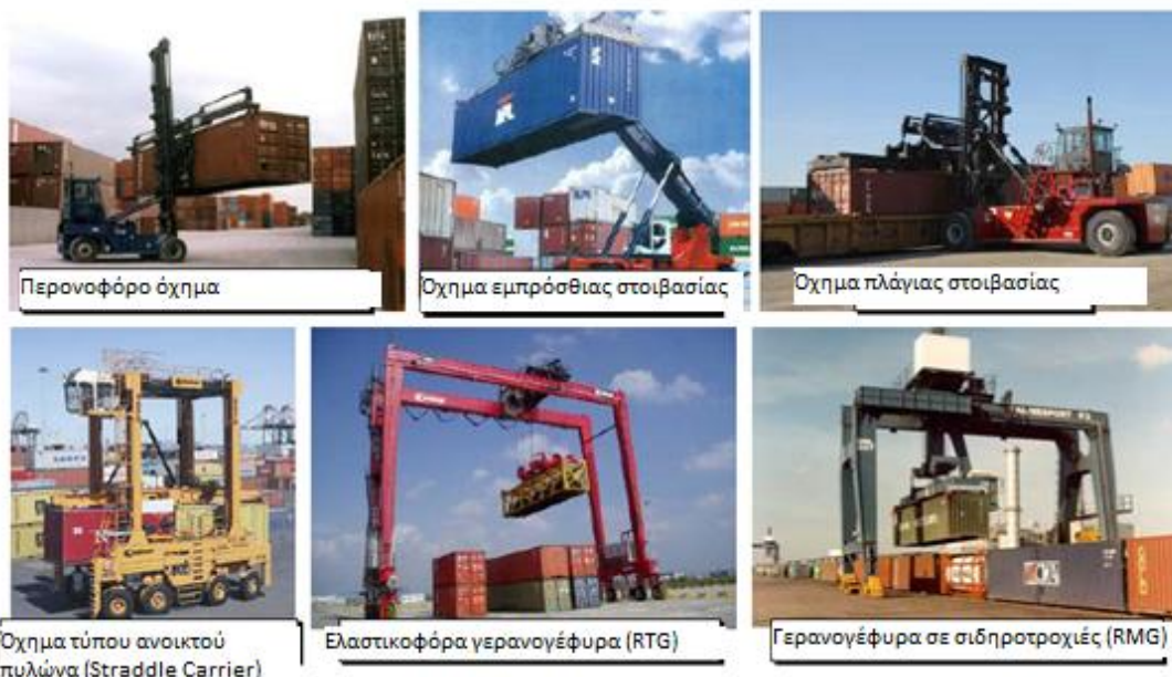
Εικόνα 9: Μηχανολογικός εξοπλισμός χώρου στοιβασίας
