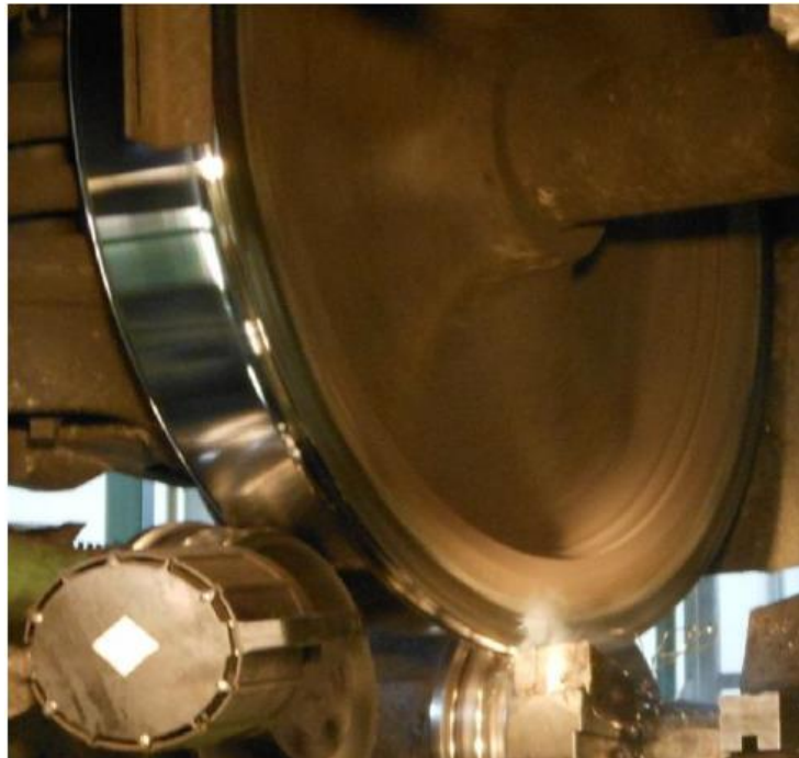
Εικόνα 2.16: Τροχός κατά τη διαδικασία της τήνωσης [21]
