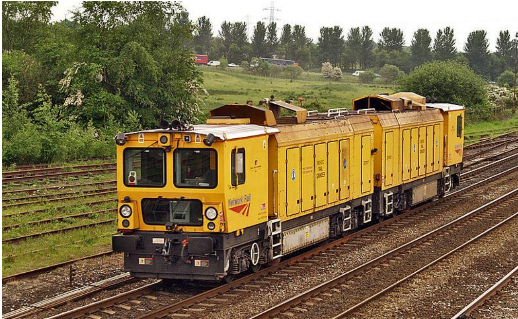
Εικόνα 2.6: Όχημα λείανσης σιδηροτροχιών [10]
