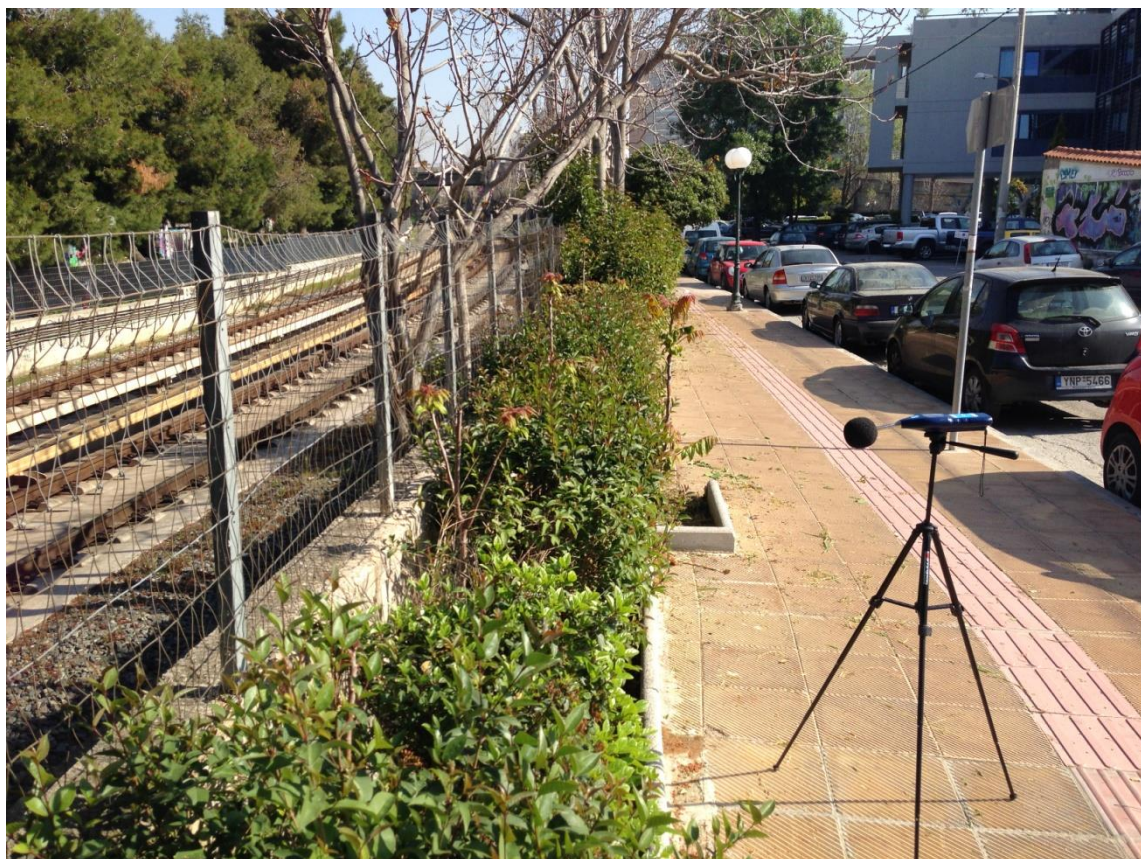
Εικόνα 5.13: Ηχόμετρο στη θέση μέτρησης πριν την τοποθέτηση των ηχοαπορροφητικών πλακών (Μετρήσεις Πέμπτη 3 Απριλίου 2014)
