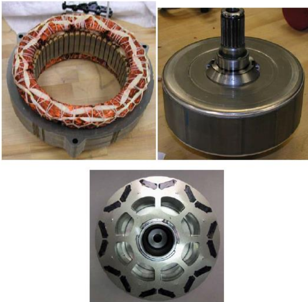
Σχήμα 2.9 : Μηχανή Prius 2010 στάτης (πάνω αριστερά), δρομέας (πάνω δεξιά) διαμόρφωση δρομέα (κάτω)
