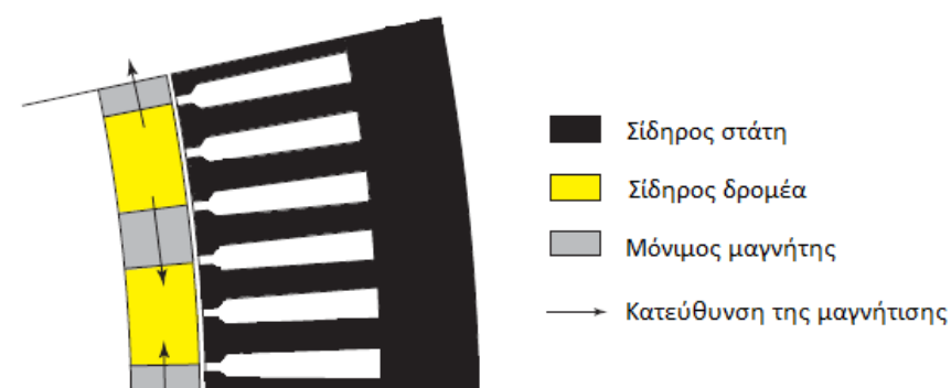
Σχήμα 2.5 : Διατομή μηχανής με εφαπτομενικούς MM (ένα ζεύγος πόλων)
