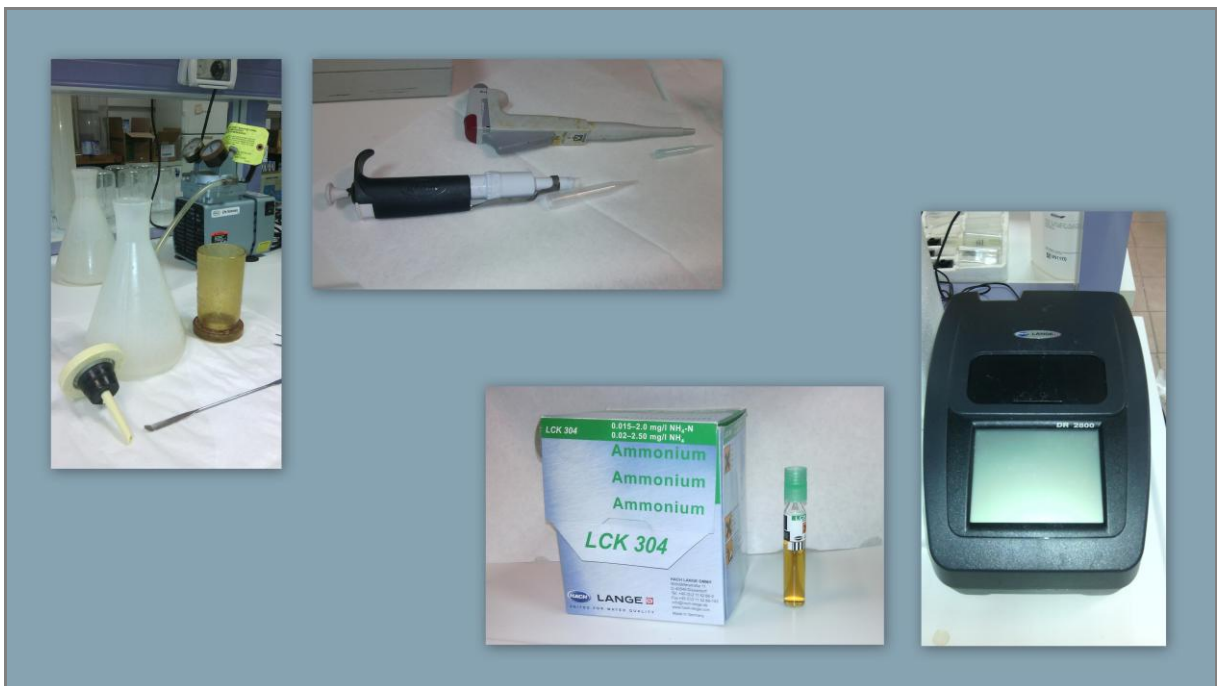
Σχήμα 3.15: Προσδιορισμός NH_4-N : Συσκευή διήθησης συνοδευόμενη από αντλία κενού, Πιπέτες, Αντιδραστήρια HACH, φασματοφωτόμετρο (από αριστερά προς τα δεξιά)
