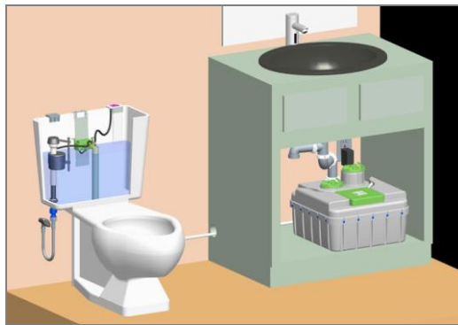
Σχήμα 2.1: Σύστημα AQUUS® για διάθεση στο καζανάκι της τουαλέτας (Πηγή: www.watersavertech.com )
