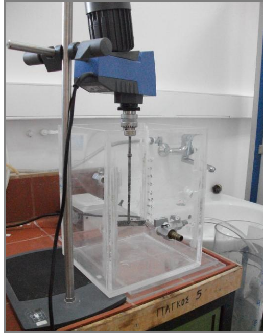
Σχήμα 3.8: Αναδευτήρας και δεξαμενή κροκίδωσης
