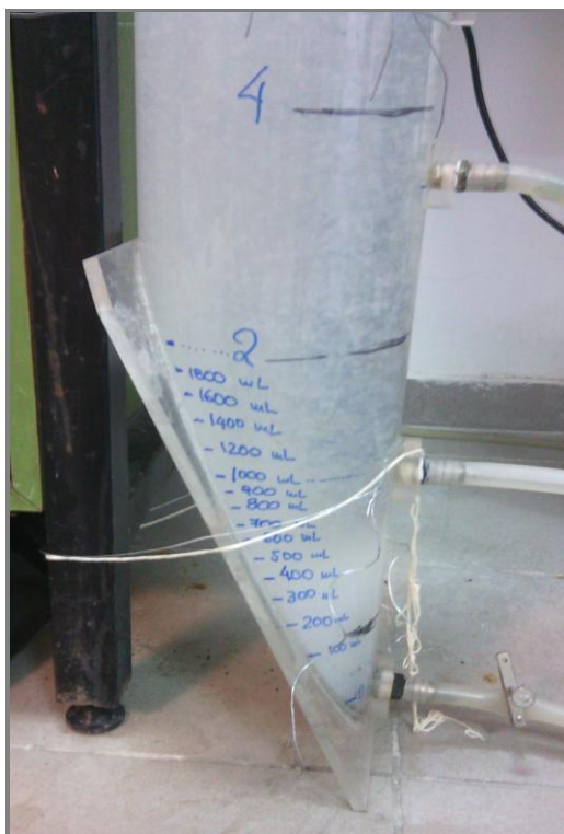
Σχήμα 3.3: Νεκρός όγκος δεξαμενής καθίζησης, χωρητικότητας 3,5 (L)
