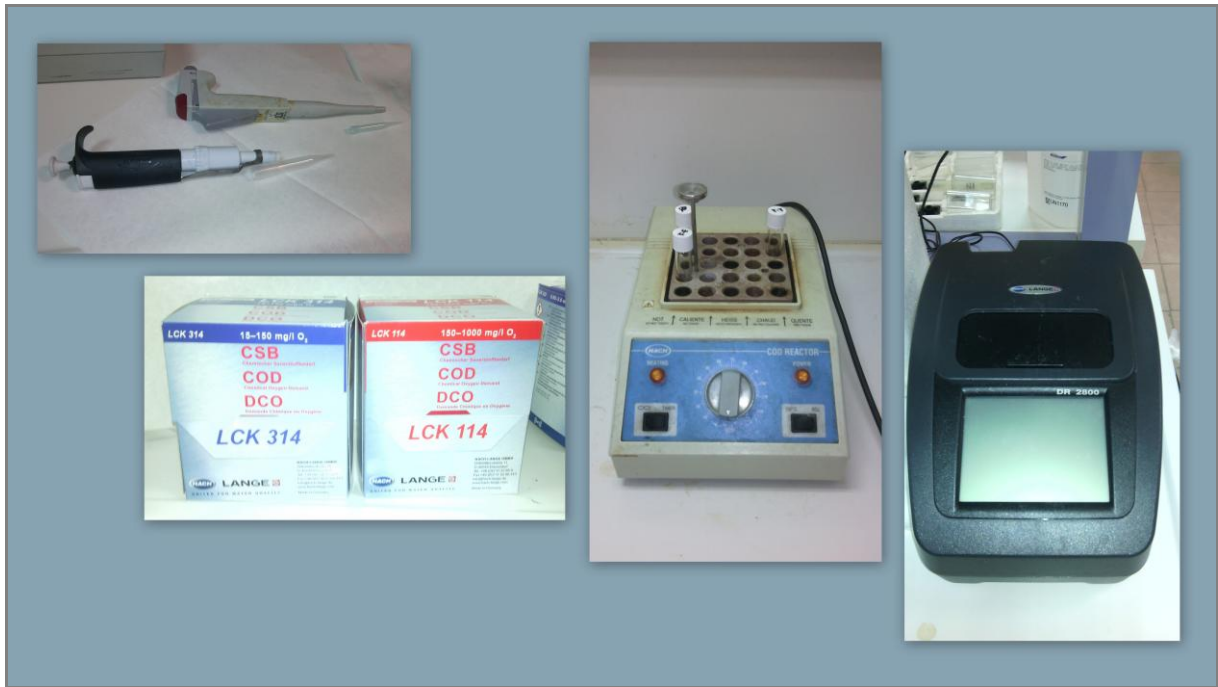
Σχήμα 3.13: Προσδιορισμός COD t : Πιπέτες, Φιαλίδια HACH, Χωνευτής, Φασματοφωτόμετρο HACH DR2000 (από αριστερά προς τα δεξιά)
