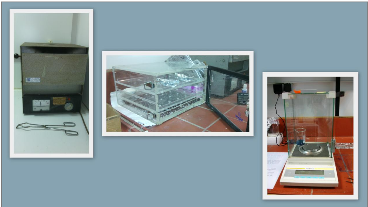
Σχήμα 3.10: Προετοιμασία φίλτρων για μέτρηση στερεών: Φούρνος 550°C , Ξηραντήρας και Ζυγός ακριβείας (από αριστερά προς τα δεξιά)
