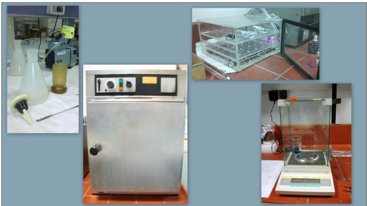
Σχήμα 3.11: Προσδιορισμός TSS: Συσκευή διήθησης συνοδευόμενη από αντλία κενού, Φούρνος 103°C, Ξηραντήρας, Ζυγός ακριβείας (από αριστερά προς τα δεξιά)
