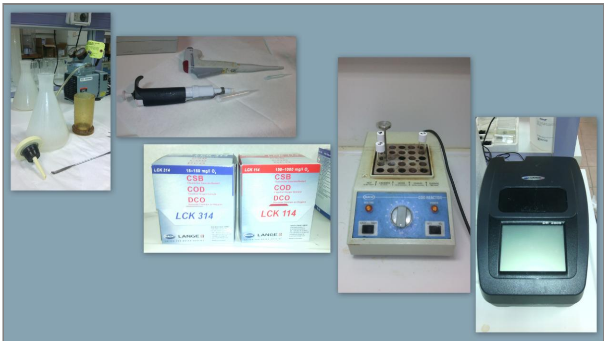
Σχήμα 3.14: Προσδιορισμός COD 5 : Συσκευή διήθησης συνοδευόμενη από αντλία κενού, Πιπέτες, Αντιδραστήρια HACH, Χωνευτής, Φασματοφωτόμετρο HACH DR2000 (από αριστερά προς τα δεξιά)
