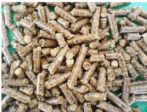
Εικ. 4.4 Μια μορφή βιομάζας: pellets (συσσωματώματα) τα οποία προκύπτουν από τη μηχανική συμπίεση πριονιδιού, χωρίς την προσθήκη χημικών ή συγκολλητικών ουσιών ( http://el.wikipedia.org/wiki/Βιομάζα )
