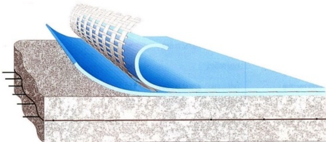
Εικ. 2.8 Πυθμένας από οπλισμένο σκυρόδεμα, αποκλειστικής κατασκευής Myrtha Pools (από το φωτογραφικό αρχείο της εταιρείας Myrtha Pools)
