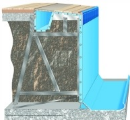
Εικ. 2.13 Κάλυψη περιμετρικού καναλιού υπερχείλισης μεγάλης αγωνιστικής πισίνας επιπέδου διεθνών διοργανώσεων, αποκλειστικής κατασκευής Myrtha Pools (απο το φωτογραφικό αρχείο της εταιρείας Myrtha Pools).
