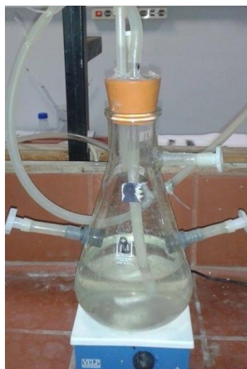
Εικόνα 4.1: Αναερόβιος αντιδραστήρας με αρχική συγκέντρωση εξασθενούς χρωμίου 1 mg/L
