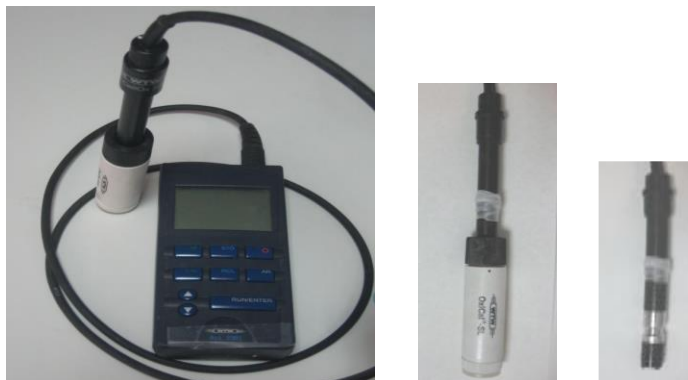
Εικόνα 3.11: Συσκευή μέτρησης DO μοντέλο Oxi 3301 της WTW
