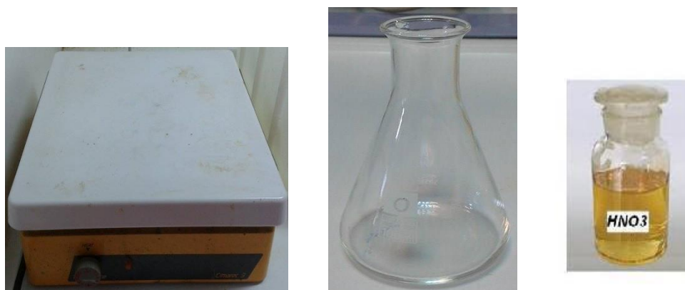
Εικόνα 3.22: Αριστερά εικονίζεται η θερμαντική πλάκα της Cimarec 3, στη μέση οι κωνικές των 100 mL και δεξιά το διάλυμα πυκνού νιτρικού οξέος \text{HNO}_3
