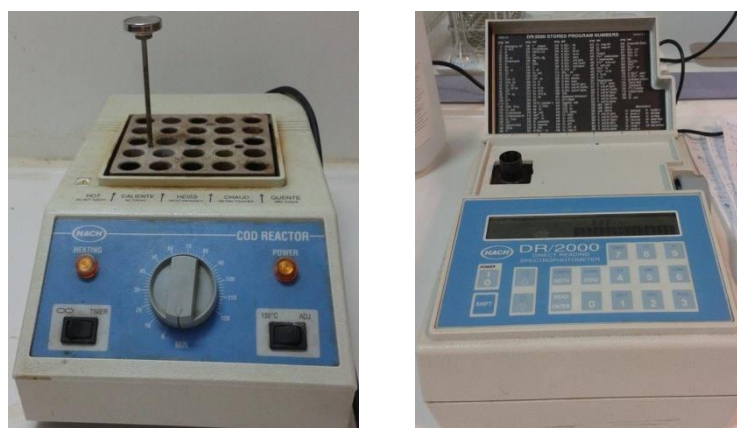
Εικόνα 3.18: Αριστερά εικονίζεται ο χωνευτής για φιαλίδια COD και δεξιά το φασματοφωτόμετρο τύπου HACH DR/2000
