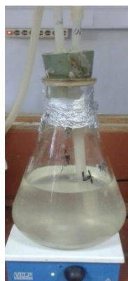
Εικόνα 4.3: Ανοξικός – αναερόβιος αντιδραστήρας με αρχική συγκέντρωση εξασθενούς χρωμίου 1 mg/L
