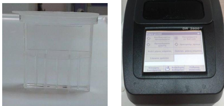
Εικόνα 3.20: Αριστερά εικονίζεται η ειδική κυψελίδα και δεξιά το φασματοφωτόμετρο τύπου HACH LANGE DR 2800
