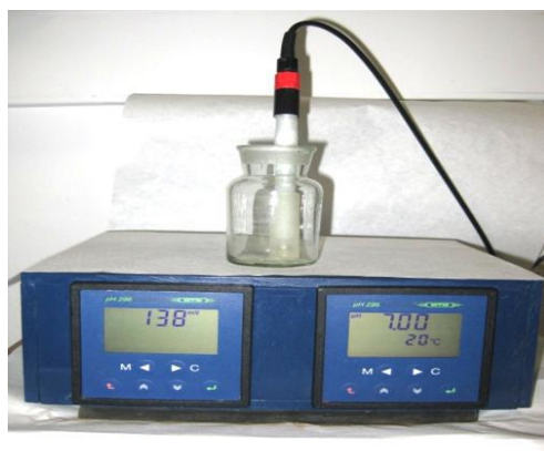
Εικόνα 3.10: Συσκευή μέτρησης Redox της WTW
