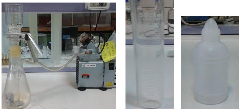
Εικόνα 3.21: Αριστερά εικονίζεται η γυάλινη μονή συσκευή διήθησης με χρήση αντλίας κενού, στη μέση ο ογκομετρικός σωλήνας 50 mL και δεξιά το πλαστικό μπουκαλάκι
