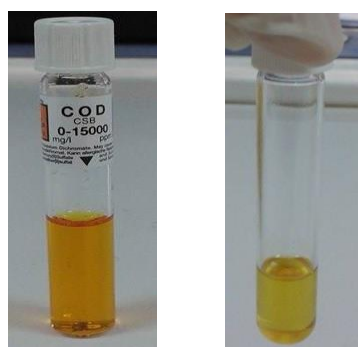
Εικόνα 3.17: Αριστερά εικονίζεται το ληγμένο αντιδραστήριο COD της Aquanal με εύρος τιμών 0 – 15000 mg/L για τη μέτρηση του COD του τυρόγαλου και δεξιά το ληγμένο αντιδραστήριο COD της Aquanal με εύρος τιμών 0 – 150 mg/L για τη μέτρηση του ολικού και διαλυτού COD
