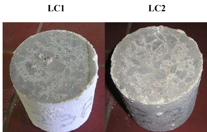
Σχήμα 7-24: Φωτογραφίες των δοκιμίων των συνθέσεων LC1 και LC2 ύστερα από 18 μήνες παραμονής τους στο διάλυμα SC10.
