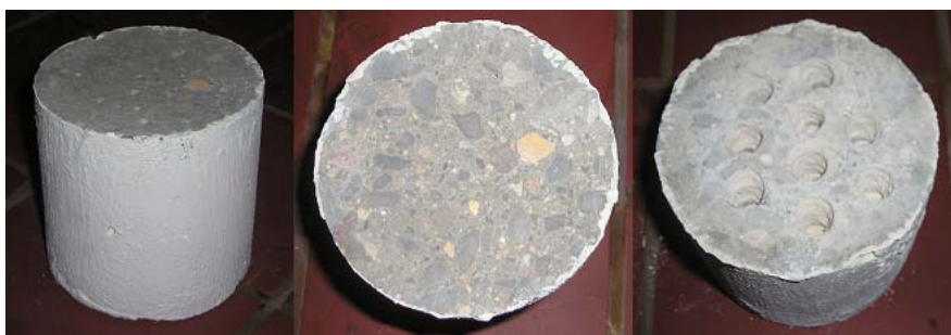
Σχήμα 5-8: Μονωμένο κυλινδρικό δοκίμιο και όψεις της επιφάνειάς του πριν και μετά την παραλαβή του προς μέτρηση υλικού.
