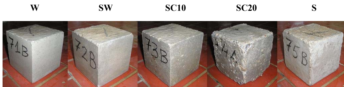
Σχήμα 6-48: Φωτογραφίες των δοκιμίων της σύνθεσης LMC ύστερα από 24 μήνες παραμονής τους στα διάφορα διαλύματα.
