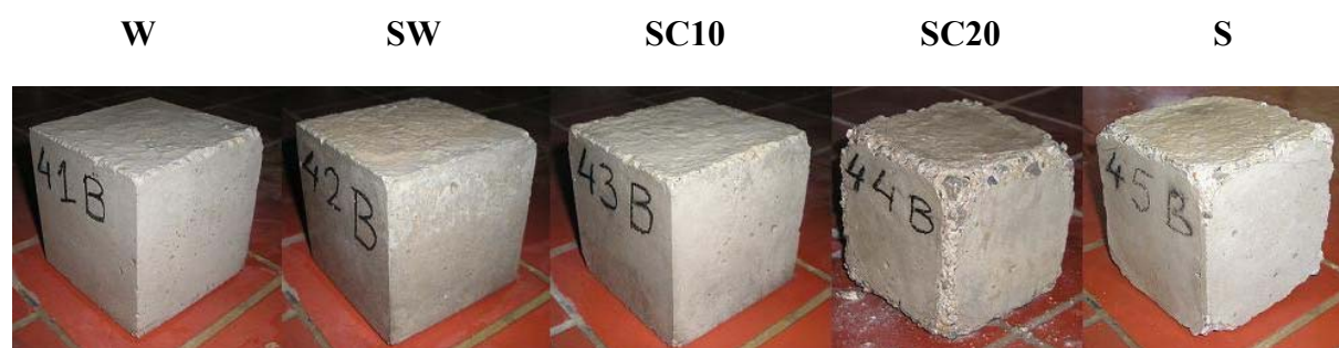
Σχήμα 6-39: Φωτογραφίες των δοκιμίων της σύνθεσης LPC ύστερα από 24 μήνες παραμονής τους στα διάφορα διαλύματα.
