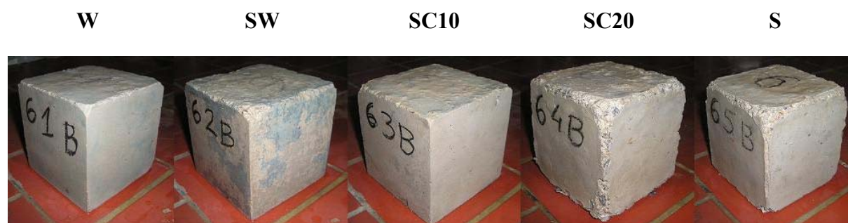
Σχήμα 6-45: Φωτογραφίες των δοκιμίων της σύνθεσης LSC ύστερα από 24 μήνες παραμονής τους στα διάφορα διαλύματα.
