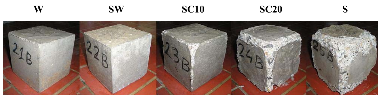
Σχήμα 6-33: Φωτογραφίες των δοκιμών της σύνθεσης LC1 ύστερα από 24 μήνες παραμονής τους στα διάφορα διαλύματα.
