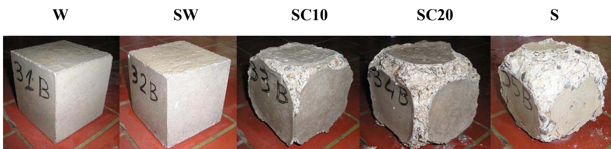
Σχήμα 6-36: Φωτογραφίες των δοκιμίων της σύνθεσης LC2 ύστερα από 24 μήνες παραμονής τους στα διάφορα διαλύματα.
