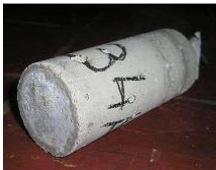
Σχήμα 8-24: Φωτογραφία δοκιμίου οπλισμένου κονιάματος της σύνθεσης LC2, που συντηρήθηκε στο διάλυμα SC20 για 5 μήνες.
