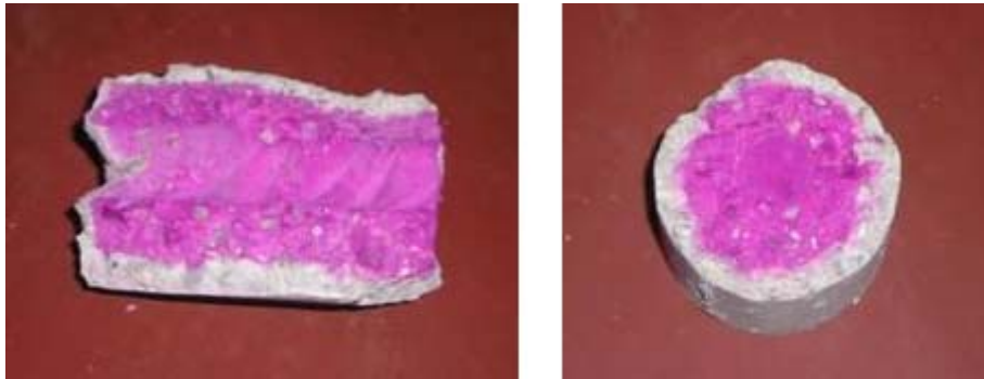
Σχήμα 5-11: «Μέτωπο» ενανθράκωσης σε δοκίμιο της σύνθεσης LC1, που παρέμεινε στο διάλυμα SC20 για 10 μήνες.
