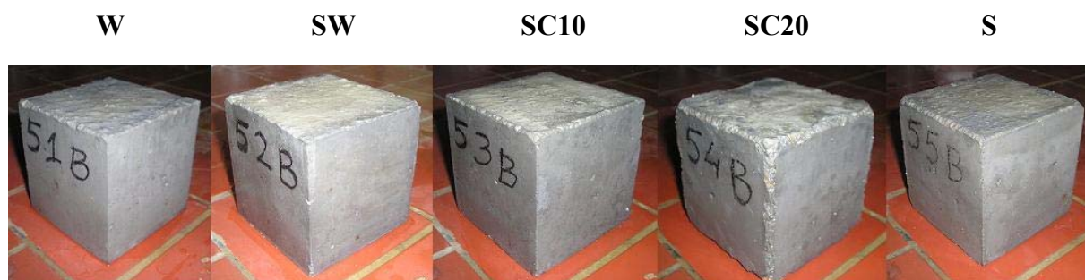
Σχήμα 6-42: Φωτογραφίες των δοκιμών της σύνθεσης LFC ύστερα από 24 μήνες παραμονής τους στα διάφορα διαλύματα.
