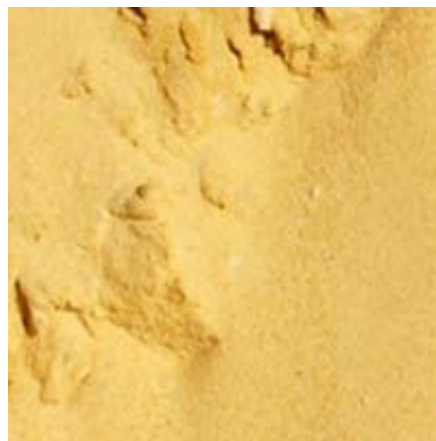
Εικόνα 3.28: Ψιλή άμμος ποταμού για το τριφτό των επιχρισμάτων
