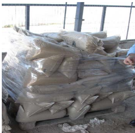
Εικόνα 3.31: Άμμος ψιλή ποταμού ανάμεικτη με μαρμαρόσκονη για τριφτά επιχρίσματα
