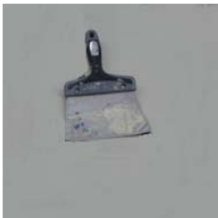
Εικόνα 2.17: Σπάτουλα διάστρωσης κόλλας πλακιδίων
