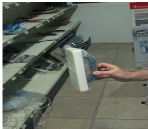
Εικόνα 3.44: Τριβίδι από φελιζόλ (διογκωμένη πολυστερίνη) για το τριφτό (τρίτη στρώση) των τριπλών τριβιδιστών επιχρισμάτων
