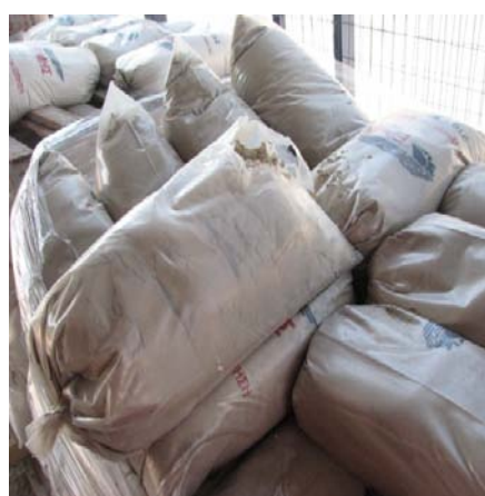
Εικόνα 3.32: Άμμος λατομείου (σπαστήρος) σε πλαστικές σακούλες για λασπώματα επιχρισμάτων
