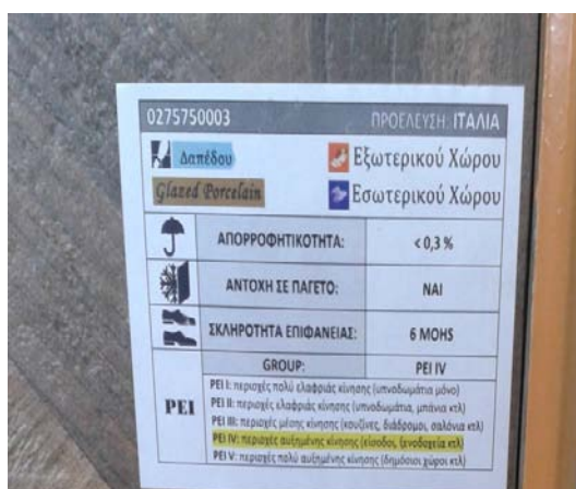
Εικόνα 2.3: Ετικέτα πλακιδίων δαπέδου στην οποία αναγράφονται τα βασικά τεχνικά χαρακτηριστικά τους
