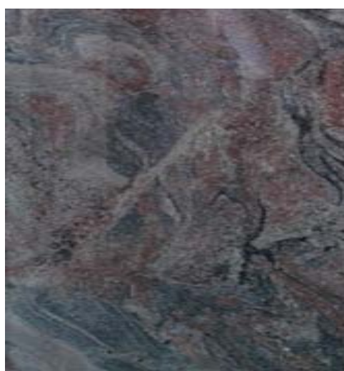
Εικόνα 2.31: Μάρμαρο Επιδαύρου (με φυσικά κοχύλια)
