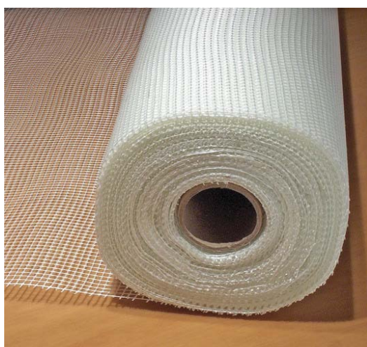
Εικόνα 4.36: Υαλόπλεγμα σοβά από fiberglass σε ρολό (πηγή: διαδίκτυο)
