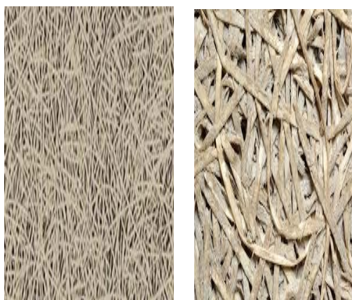
Εικόνα 4.12: Λεπτομέρειες των ινών της πλάκας Heraclith
