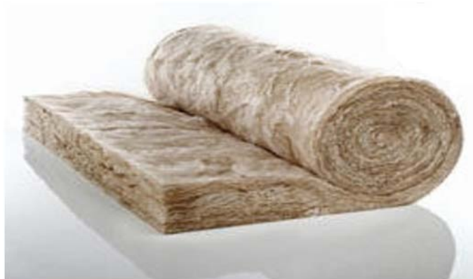
Εικόνα 4.7: Φυσικός ορυκτοβάμβακας σε ρολό (60cm ή 120 cm) x (περ.10 m) x( 3-10) cm, οικολογικός, θερμοηχομόνωση, αντίσταση στη φωτιά (κατηγορία A1), για ξηρή δόμηση (πάνελ γυψοσανίδων), \lambda=0,037 W/Mk (απλός)
