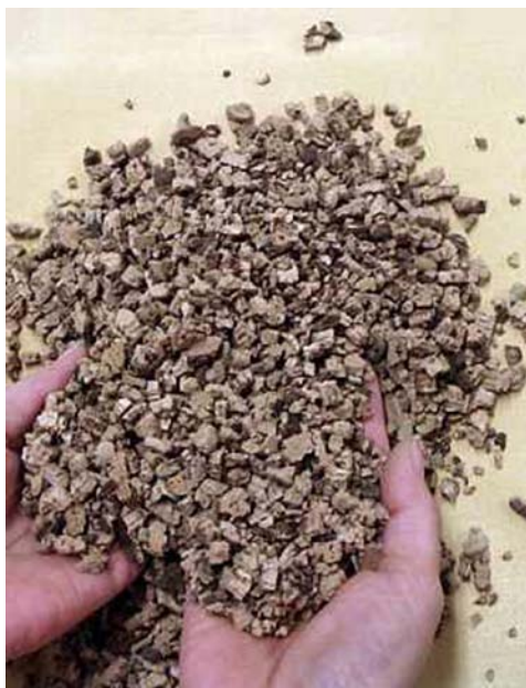
Εικόνα 4.17: Χυτή μόνωση με φελλό
