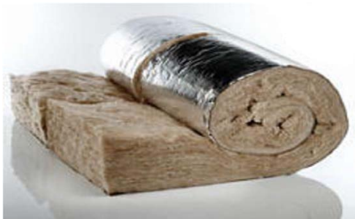
Εικόνα 4.8: Φυσικός ορυκτοβάμβακας σε ρολό με αλουμίνιο 120cm x (περ.10 m) x (3 -12) cm, οικολογικός, θερμοχομόνωση, αντίσταση στη φωτιά (κατηγορία A1), για σκεπές, ψευδοροφές, καρφωτά πατώματα, σωλήνες, \lambda = 0,04 w/Mk (απλός, οικονομικός) (πηγή: http://www.tsakiroglou.gr/ )
