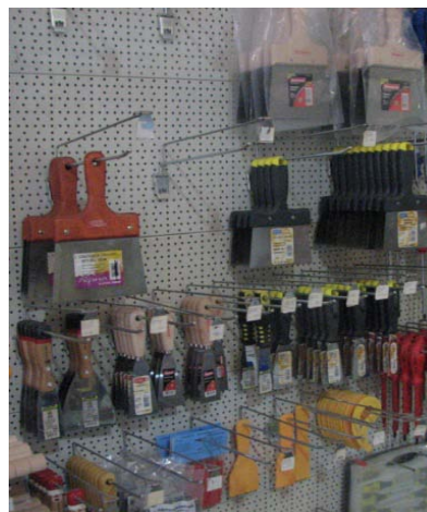
Εικόνα 2.23: Σπάτουλες διάστρωσης κόλλας πλακιδίων (φαρδιές), στοκαρίσματος αρμών (στενές) και άλλων χρήσεων
