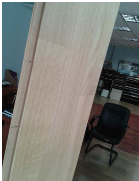
Εικόνα 2.46: Προγουλισμένες λωρίδες από δύο στρώσεις ξύλου συνολικού πάχους 12 mm, ραμποτέ, για προγουλισμένο δάπεδο επικολλημένο επάνω σε τσιμεντοκονία ή μωσαϊκό (κολλητό δάπεδο)
