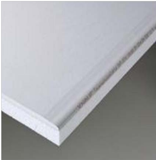
Εικόνα 4.38: Θερμομονωτικό πάνελο παραμένοντος ξυλοτύπου Knauf Betoboard Standard ανθυγρής γυψοσανίδας GKI H2 12.5mm με διογκωμένη πολυστερίνη PS 25mm. Διαστάσεις: 1200X2500mm(πηγή: διαδίκτυο)
