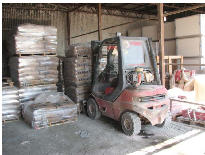
Εικόνα 3.13: Σάκκοι οικοδομικών κονιών πάνω σε παλέτες σε στεγασμένη αποθήκη οικοδομικών υλικών και παλετοφόρο ανυψωτικό όχημα (κλάρκ) για τη μεταφορά και φόρτωση των παλετών επί του φορτηγού αυτοκινήτου μεταφοράς τους στο εργοτάξιο
