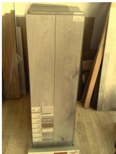
Εικόνα 2.51: Λωρίδες laminate διαστάσεων 120x20x0.7 ή 0,9 [cm] έτοιμες για δάπεδο ραμποτέ πάνω σε αντιθορυβικό υπόστρωμα, το οποίο τοποθετείται πάνω σε τσιμεντοκονία ή παλαιό μωσαϊκό χωρίς κόλλα και χωρίς καρφιά (κολυμβητό δάπεδο)
