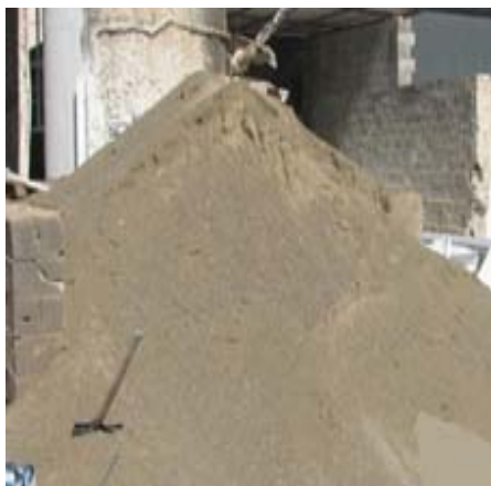
Εικόνα 3.27: Υπαίθριος σωρός χονδρής άμμου ποταμού για λασπώματα, σκυροδέματα
