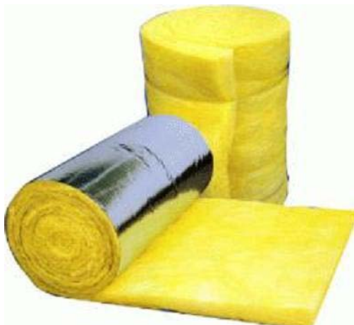
Εικόνα 4.1: Υαλοβάμβακας σε ρολό με ή χωρίς επικάλυψη αλουμινίου, σε πάχη 3,4,5 cm για θερμοηχομόνωση, \lambda=0,031-0,043 \text{ W/mK}
