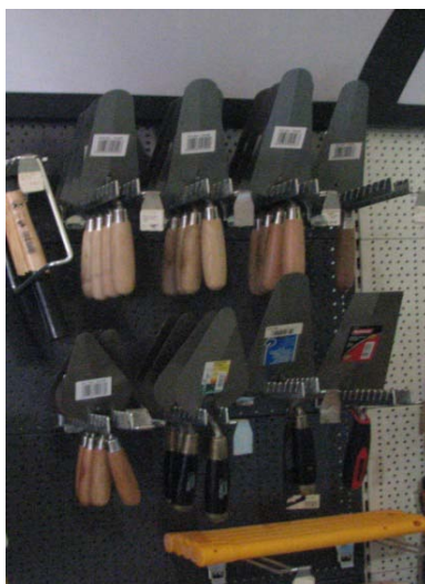
Εικόνα 2.24: Διάφορα μυστριά για την αρχική διάστρωση του τσιμεντοκονιάματος
