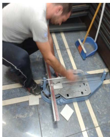
Εικόνα 2.20: Χειροκίνητος κόφτης κεραμικών πλακιδίων δαπέδου και τοίχου
