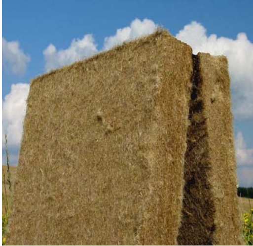
Εικόνα 4.32: Θερμομονωτικές πλάκες από λινάρι
