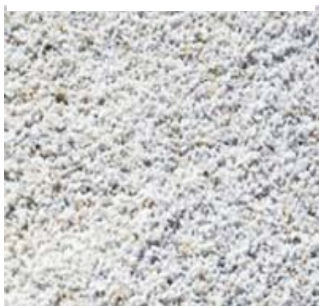
Εικόνα 3.29: Μαρμαρόσκονη Διονύσου για το τριφτό των επιχρισμάτων
