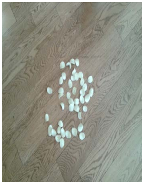
Εικόνα 2.65: Κοχύλια πολυουραιθάνης για ηχομόνωση κλασικού καρφωτού ξύλινου δαπέδου που γεμίζουν τα κενά ανάμεσα στα καδρόνια του δαπέδου
