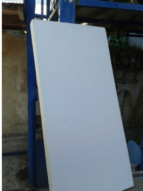
Εικόνα 4.21: Φύλλο HPS 80 διογκωμένης πολυστερίνης που πληροί την ETA (Ευρωπαϊκή Τεχνική Έγκριση) για εξωτερικές θερμομονώσεις (στεγανωτικό αλλά διαπνέον σύστημα)
