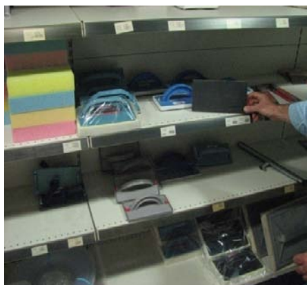
Εικόνα 3.43: Σφουγγάρια και τριβίδια για τριφτά τριβιδιστά σοβατίσματα (επιχρίσματα)
