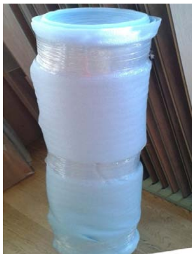
Εικόνα 2.53: Υπόστρωμα laminate αντιθορυβικό, αφρώδες σε ρολό (φθηνό) μικρή απορρόφηση κτυπογενούς ήχου
