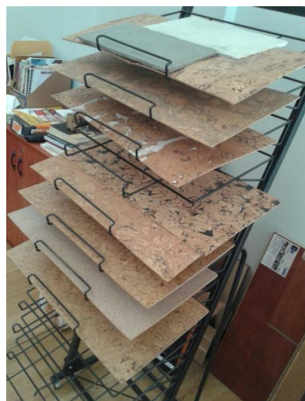
Εικόνα 2.66: Ηχοαπορροφητικά φύλλα συνθετικού φελλού για ηχομόνωση ξύλινου δαπέδου
