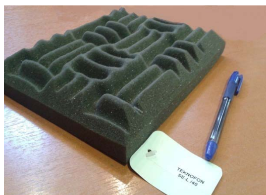
Εικόνα 4.57: Ηχοαπορροφητικά υλικά τύπου αυγοθήκης και λαβυρίνθων αντίστοιχα
