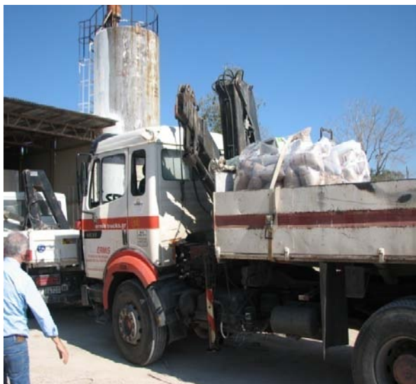
Εικόνα 2.11: Φορητό αυτοκίνητο με εγκατεστημένο γερανάκι (παπαγαλακι) για μεταφορά και ανύψωση οικοδομικών υλικών (σάκκων άμμου, τσιμέντου, ασβεστοπολτού) και παλετών με πλακίδια
