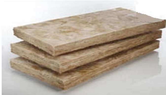
Εικόνα 4.6: Φυσικός ορυκτοβάμβακας σε φύλλα 60cm x135cm x(4,5-15) cm, σχετικά οικολογικός, θερμοηχομόνωση, αντίσταση στη φωτιά (κατηγορία A1),για στέγες και ξηρή δόμηση, \lambda=0,037 W/mK
