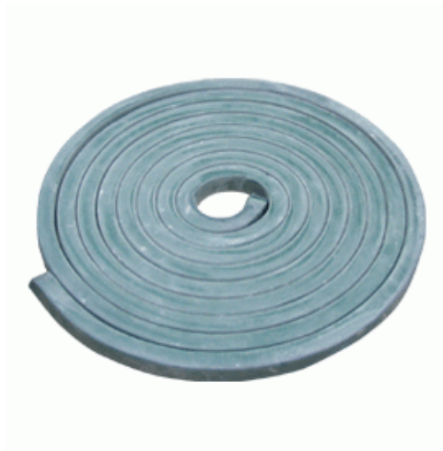
Εικόνα 4.54: Αρμοταινία για στεγάνωση αρμών διακοπής εργασίας του οπλισμένου σκυροδέματος (πηγή: διαδίκτυο)
