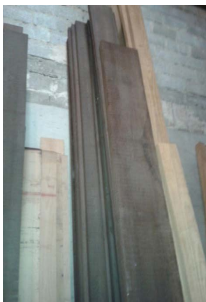
Εικόνα 2.63: Τρόπος στοιβαξης ξυλείας
