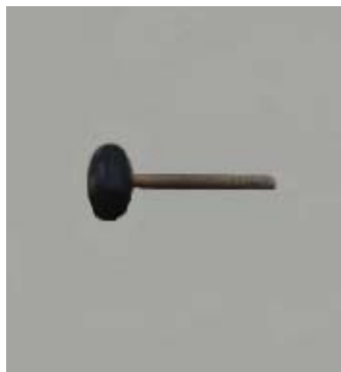
Εικόνα 2.18: Σφυρί από συνθετικό υλικό (ματσόλα) για το κτύπημα των προς επικόλληση πλακιδίων δαπέδου
