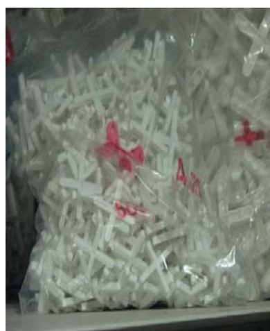
Εικόνα 2.21: Πλαστικά σταυρουδάκια για την εξασφάλιση ισοπαχών αρμών κατά την τοποθέτηση κεραμικών πλακιδίων δαπέδου και τοίχου
