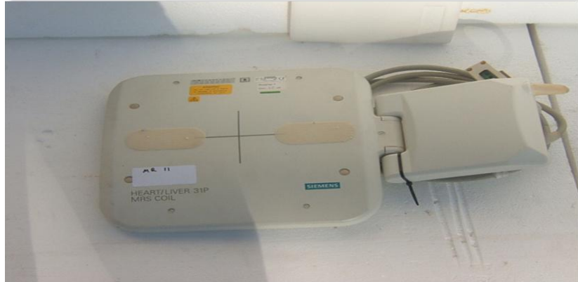
Εικόνα 2.12: Τυπική διάταξη ενός πηνίου επιφανείας για την εξέταση του ήπατος και της καρδιάς (Πηγή: http://www.magnet.fsu.edu )
