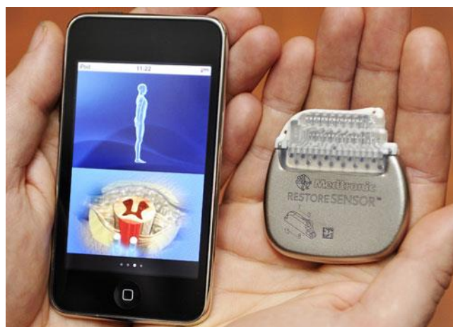
Εικόνα 67. Ο Νευροδιεγέρτης και ο Χειρισμός του (208).
