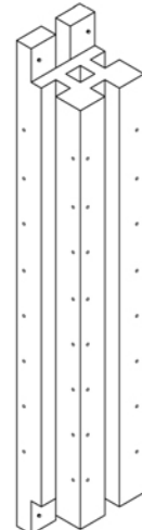
υποστυλώμα ορόφου ύψους 2,90m που τοποθετείται στην οριζόντια ένωση των τοίχων
