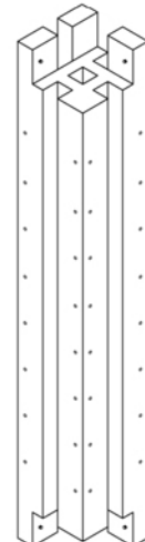
υποστυλώμα ορόφου ύψους 2,90m που τοποθετείται στις γωνίες του κτιρίου
