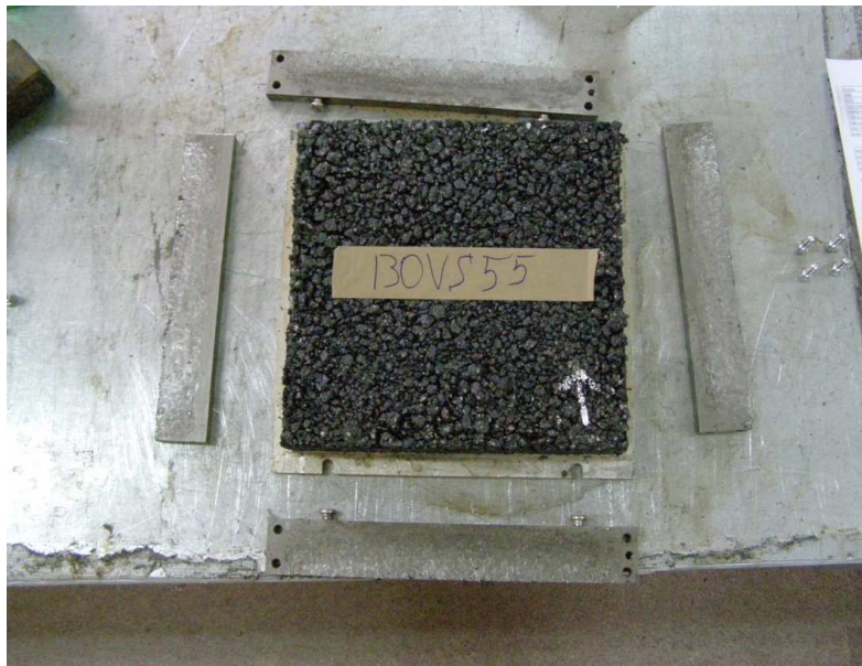
Σχήμα 6.5 Δοκίμιο μίγματος αντιολισθηράς στρώσης την στιγμή της εξαγωγής του από τη μήτρα
