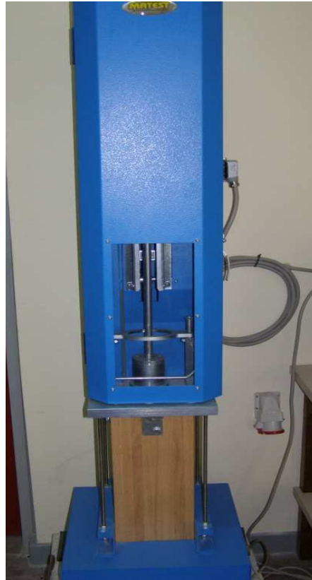
Σχήμα 4.4 Συσκευή συμπίκνωσης με κρουστικό φορτίο τύπου Marshall
