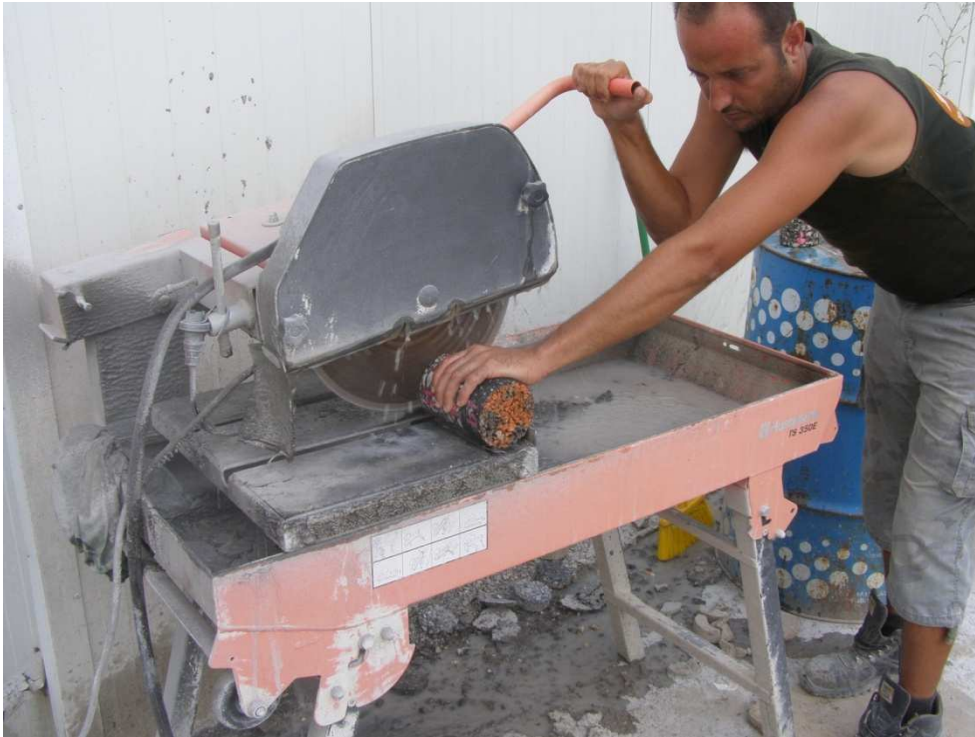
Σχήμα 4.13 Διαχωρισμός πυρήνων σε στρώσεις
