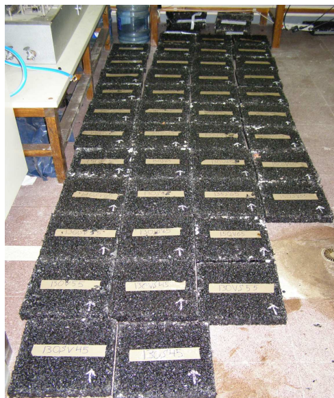
Σχήμα 6.4 Δοκίμια μετά την εξαγωγή τους από τις μήτρες
