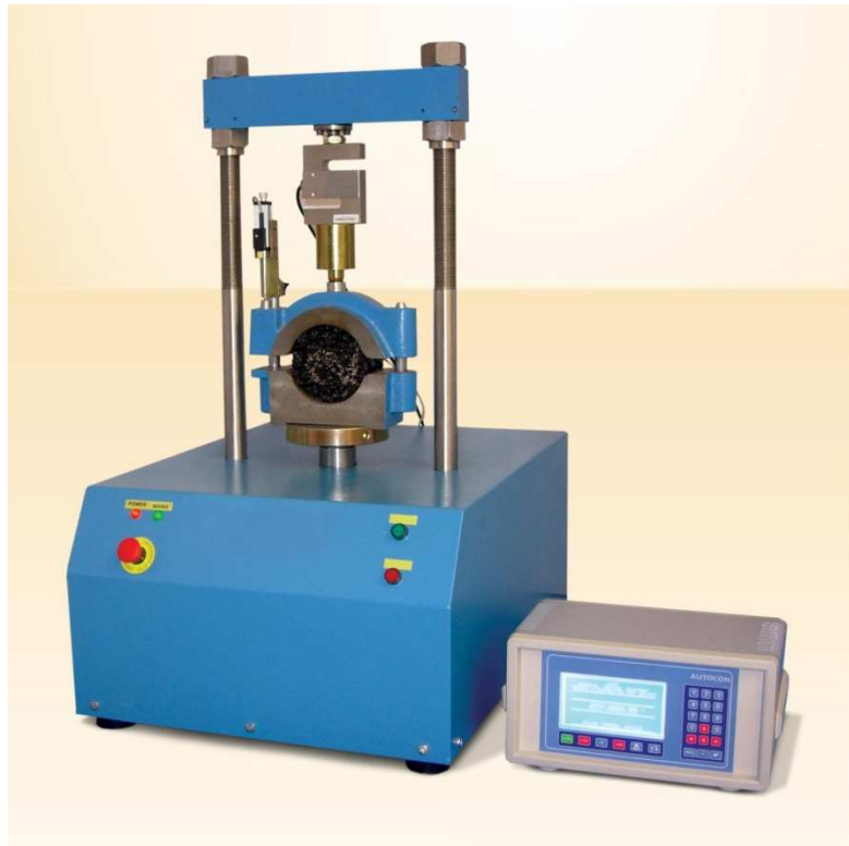
Σχήμα 4.7 Συσκευή προσδιορισμού ευστάθειας και υποχώρησης Marshall
