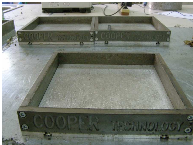
Σχήμα 6.3 Μήτρες συμπίκνωσης ασφαλτομίγματος
