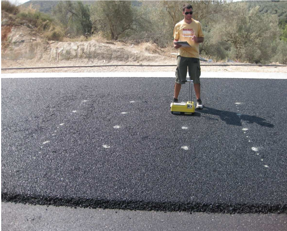
Σχήμα 4.11 Μετρήσεις συμπίκνωσης με το πυρηνικό όργανο troxler
