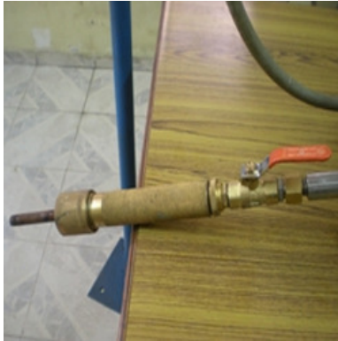
Εικόνα 17: Λαβή θερμικής λόγχης ( lance holder)( πηγή: http://www.implexmobilewelding.co.uk/thermic-cutting-boring.shtml )
