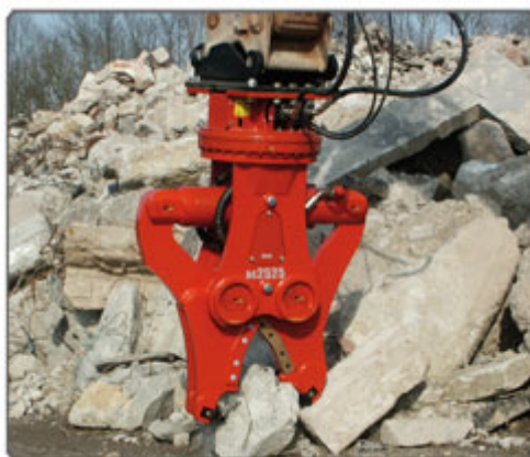
Εικόνα 13: Υδραυλική σιαγώνα η οποία πραγματοποιεί δευτερεύοντα θρυμματισμό. (πηγή: www.husqvarna.com )
