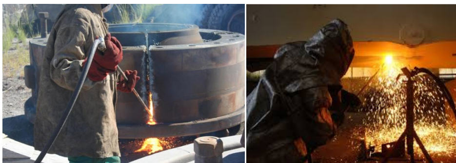
Εικόνα 16: κοπή διαφόρων υλικών με θερμική λόγχη(πηγή: http://www.implexmobilewelding.co.uk/thermic-cutting-boring.shtml )
