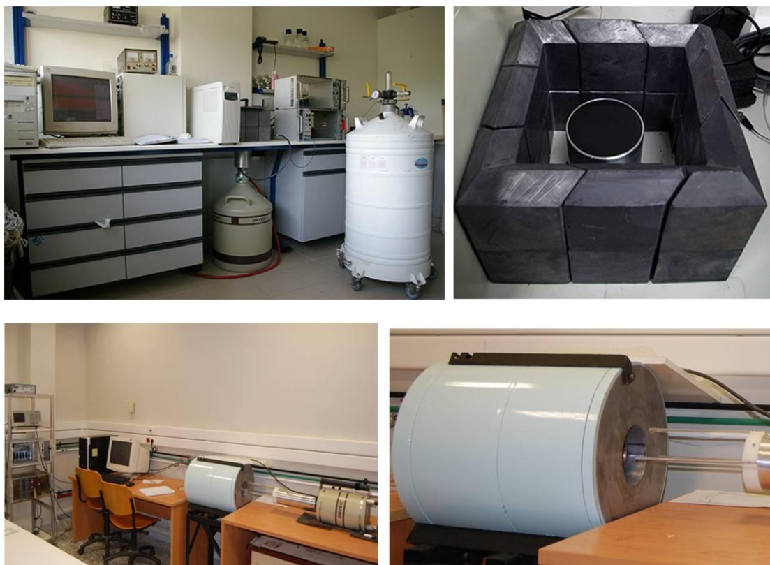
Σχήμα 3.19. Οι ανιχνευτικές διατάξεις του GEM-FX8530P4 με τις αντίστοιχες θωρακίσεις στο ΕΛ.ΚΕ.ΘΕ. (πάνω) και στο ΕΜΠ (κάτω).
