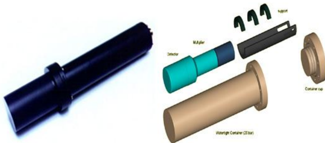
Σχήμα 3.4. Ο ανιχνευτής RADAMIII (αριστερά) και γράφημα του εσωτερικού και του εξωτερικού μέρους του ανιχνευτή KATERINA (δεξιά).
