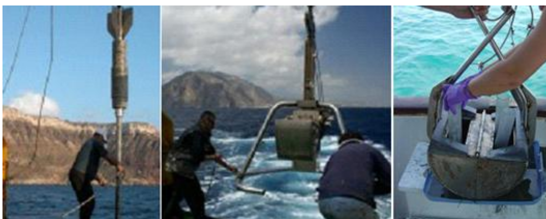
Σχήμα 3.2. Χαρακτηριστικές δειγματοληψίες ιζήματος στο πεδίο με χρήση προικολήπτη βαρύτητας (δεξιά) και αρπάγες ιζήματος τύπου Ponar (κέντρο) και Van Veen (αριστερά).
