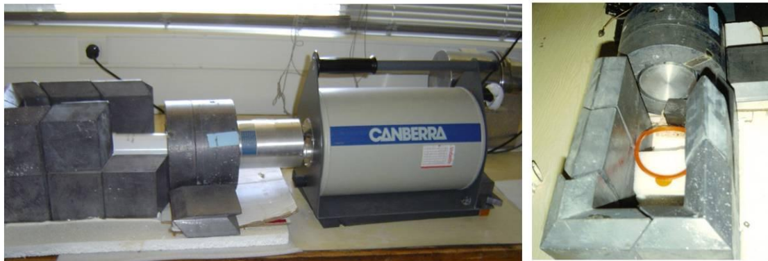
Σχήμα 3.22. Ανιχνευτής και θωράκιση HPGe στο ΕΚΕΦΕ “Δημόκριτος”.
