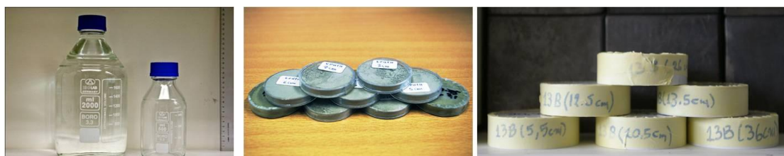
Σχήμα 3.15. Γεωμετρίες απευθείας μέτρησης δειγμάτων νερού – 2.2 L και 0.6 L (αριστερά) – και ιζήματος – 5.4 (κέντρο) και 65.4 cm 3 (δεξιά) – με φασματοσκοπία-γ.
