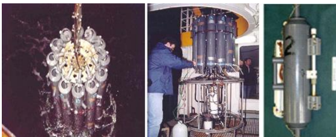
Σχήμα 3.3. Μεθοδολογία δειγματοληψίας νερού σε διάφορα βάθη με ροζέτα (αριστερά, κέντρο) εφοδιασμένη με φιάλες Niskin (δεξιά).
