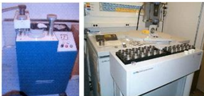
Σχήμα 3.14. Το υδραυλικό πιεστήριο (αριστερά) και το φασματομέτρο φθορισμού ακτίνων-Χ (δεξιά) που χρησιμοποιήθηκε για τις μετρήσεις των βαρέων μετάλλων στο ίζημα.
