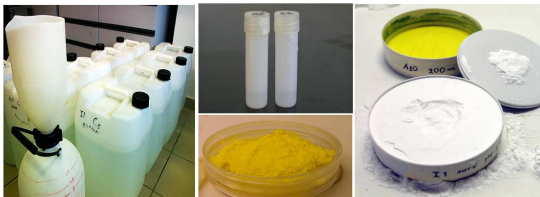
Σχήμα 3.16. Δοχεία ογκομέτρησης και αποθήκευσης δειγμάτων νερού 20 L (αριστερά), φιαλίδια ιχνηθέτη 134 Cs 1 ml (κέντρο πάνω), δόση απορροφητή AMP 15 gr (κέντρο κάτω) και δείγμα προσυγκεντρωμένου ιζήματος 137 Cs πριν και μετά την πλήρωσή της με πούδρα (δεξιά).
