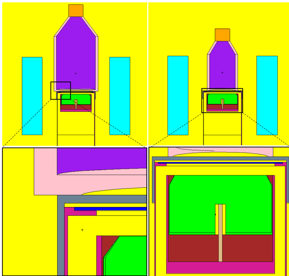
Σχήμα 4.7. Σχηματική αναπαράσταση της προσομοιωμένης ανιχνευτικής διάταξης HPGe για τις γεωμετρίες μεγάλου και μικρού μπουκαλιού σε επαφή, με το πρόγραμμα γραφικών VisED.
