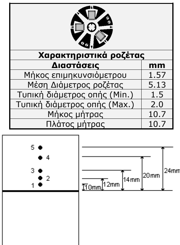
Εικόνα 11.1 Θέσεις μέτρησης των παραμενουσών τάσεων και αποστάσεις από τον άξονα συγκόλλησης
