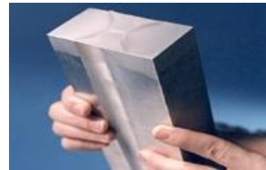
Εικόνα 2.20 Συγκόλληση FSW ελασμάτων αλουμινίου πάχους 50mm
