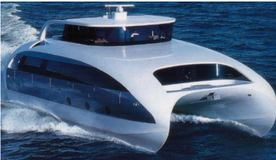
Εικόνα 1.10 Σκάφος αναψυχής τύπου καταμαράν κατασκευασμένο εξολοκλήρου από κράμα αλουμινίου
