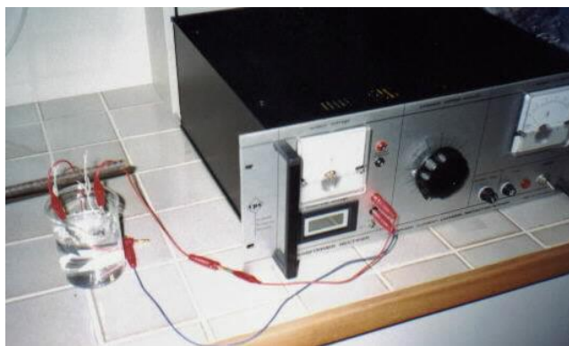
Εικόνα 5.9 Το κύκλωμα ηλεκτροχημικής προσβολής που χρησιμοποιήθηκε (ιδιοκατασκευή)
