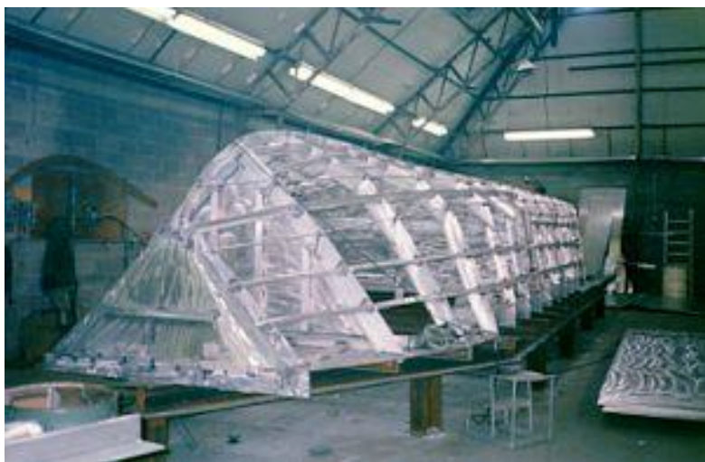
Εικόνα 1.8 Αλουμινένια γάστρα μικρού σκάφους
