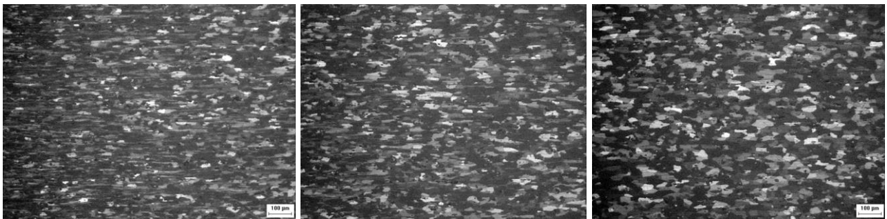
Εικόνα 6.26 Η μικροδομή της Θ.Ε.Ζ. x100 α) Μακριά από το μέταλλο συγκόλλησης, β) στο μέσο της Θ.Ε.Ζ., γ) κοντά στη ζώνη σύνδεσης
