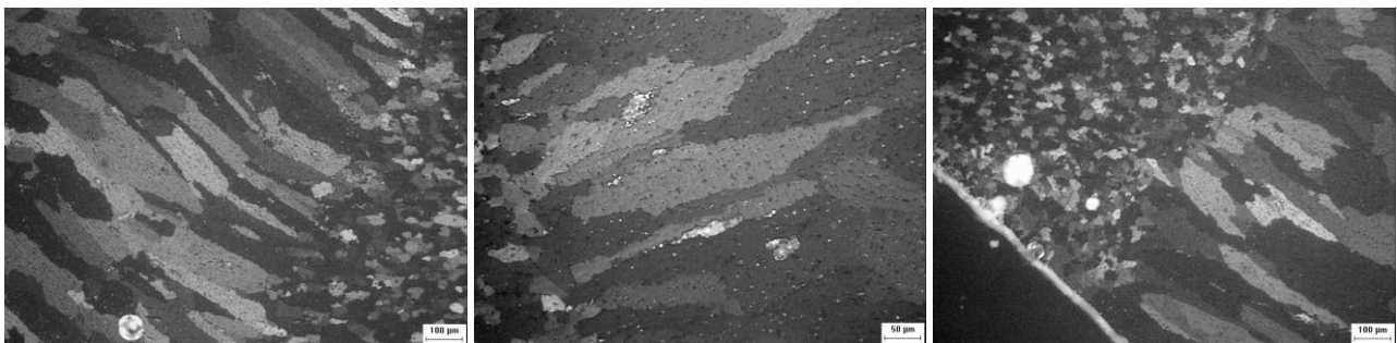
Εικόνα 6.27 Η μικροδομή στην περιοχή της ζώνης σύνδεσης σε παρατήρηση με χρήση πολωμένου φωτός. α) x100, β) x200, γ) Στην περιοχή της ρίζας x100
