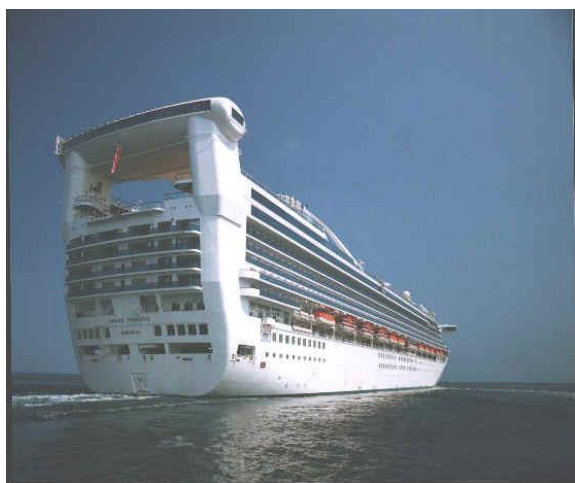
Εικόνα 1.12 Κρουαζιερόπλοια με υπερκατασκευές από κράματα αλουμινίου
