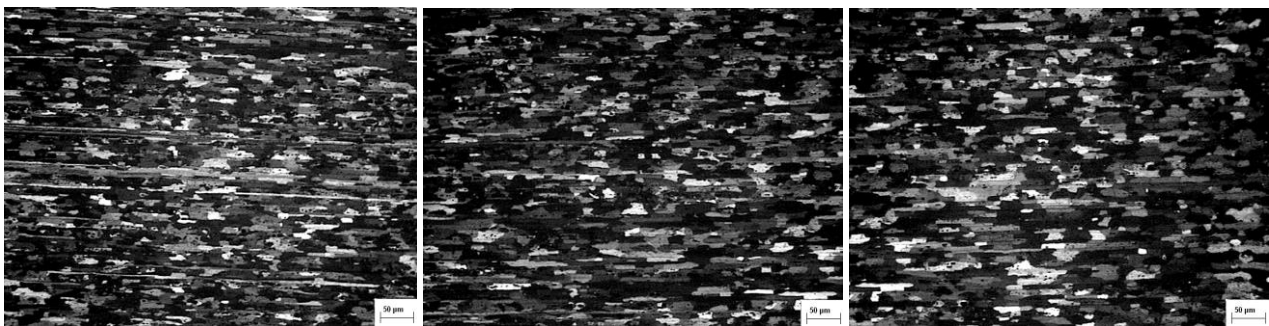
Εικόνα 6.18 Η μικροδομή της Θ.Ε.Ζ. x100 α) Μακριά από το μέταλλο συγκόλλησης, β) στο μέσο της Θ.Ε.Ζ., γ) πιο κοντά στη ζώνη σύνδεσης
