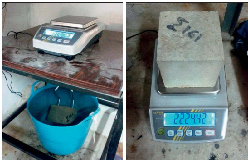
Σχήμα 260 Υπολογισμός ανοιχτού πορώδους σε πρότυπα κυβικά δοκίμια ( 100 \times 100 \times 100 mm) μέσω προσδιορισμού μαζών (α) σε νερό υπό άνοση και (β) σε αέρα [πηγή: Βούκια (2013)]
