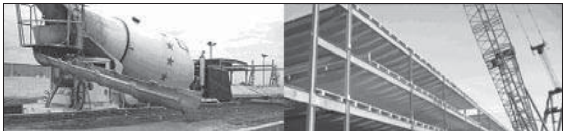
Σχήμα 5 Παραγωγή διπλών Τ, Εμπορικά Προϊόντα Σκυροδέματος, Chambersburg, Πενσυλβανία, ΗΠΑ [πηγή: ACI 237R (2007) ]
