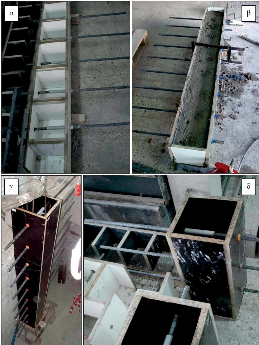
Σχήμα 102 Ξυλότυποι (α) κυβικών δοκιμίων, (β) οριζόντιου δοκιμίου, (γ) κατακόρυφου δοκιμίου μεγάλου ύψους και (δ) κατακόρυφου δοκιμίου μικρού ύψους
