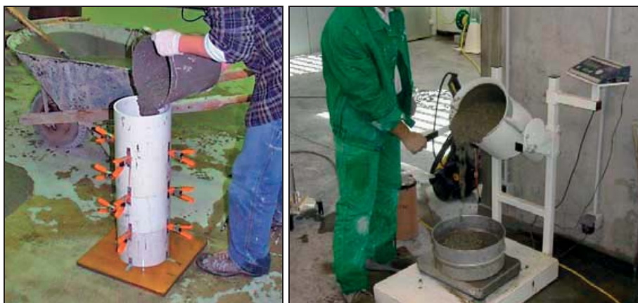
Σχήμα 18 (α) Εξοπλισμός δοκιμής απόμιξης στήλης σκυροδέματος [πηγή: D' Ambrosia et al. (2007)] (β) Εξοπλισμός δοκιμής σταθερότητας μέσω κοσκίνισης [πηγή: ACMC (2005)]
