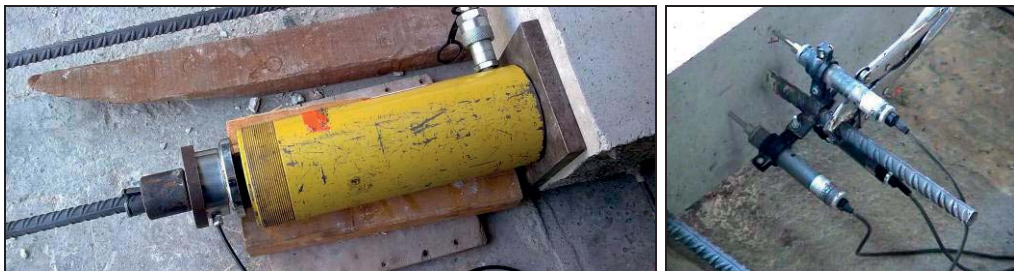
Σχήμα 105 Διάταξη δοκιμής εξόλκευσης: (α) εφελκυσμένο άκρο ράβδου (β) άτονο άκρο ράβδου
