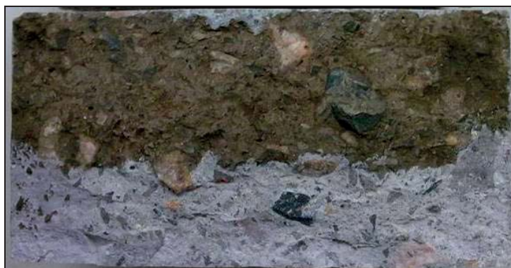
Σχήμα 346 Τυπικό προφίλ δοκιμίου σκυροδέματος κατόπιν δοκιμής αντίστασης σε χλωριόντα, σύμφωνα με το πρότυπο NordTest Build 492 (1999) και ψεκασμού με νιτρικό άργυρο
