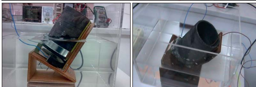
Σχήμα 344 Πειραματική διάταξη δοκιμής αντίστασης σε χλωριόντα κατά NordTest Build 492 (1999) [πηγές: Παύλου (1010), προσωπικό φωτογραφικό αρχείο]
