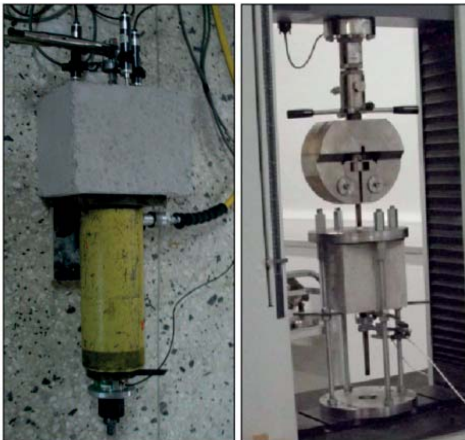
Σχήμα 250 Διάταξη δοκιμής εξόλκευσης (α) ΕΩΣ/ΕΜΠ και (β) ΕΔΥ/ΠΚ
