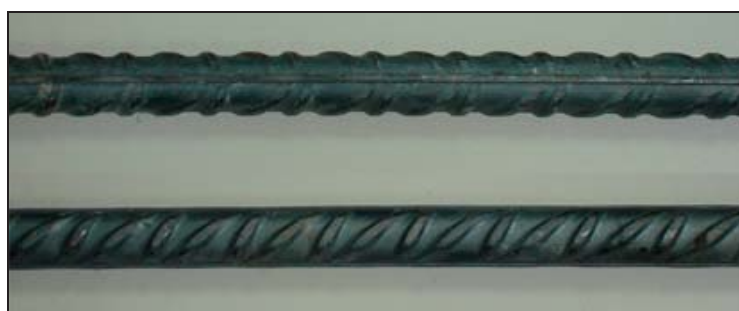
Σχήμα 59 Τυπική ράβδος οπλισμού B500C, ονομαστικής διαμέτρου d_{nom} = 16 mm
