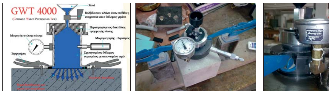
Σχήμα 301 Συσκευή υδατοαπορροφητικότητας: (α) σκαρίφημα [πηγή: Germann Instruments (1999)] (β) φωτογραφία από έλεγχο δοκιμίου (γ) λεπτομέρεια συσκευής GWT-4000.
