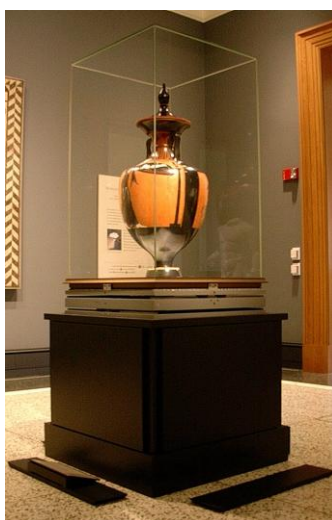
Σχ. 4.5 : Σεισμική μόνωση σε αμφορέα
