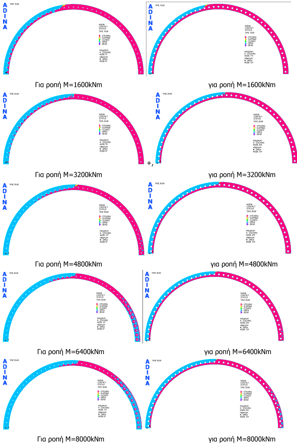
Σχήμα 6-34: επιφάνειες επαφής για διάφορες τιμές της επιβαλλόμενης ροπής για κοχλίες διαμέτρου M20 αριστερά και M36 δεξιά
