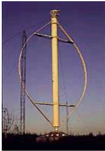
Σχήμα 1-2: ανεμογεννήτρια κατακόρυφου άξονα [4]
