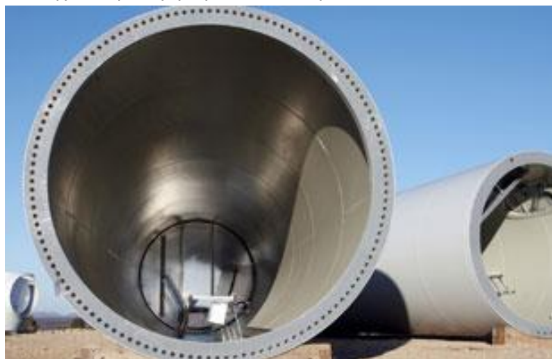
Σχήμα 3-1: κυκλικοί δακτύλιοι τμημάτων πυλώνα (πηγή: www.sustainablemfr.com )
