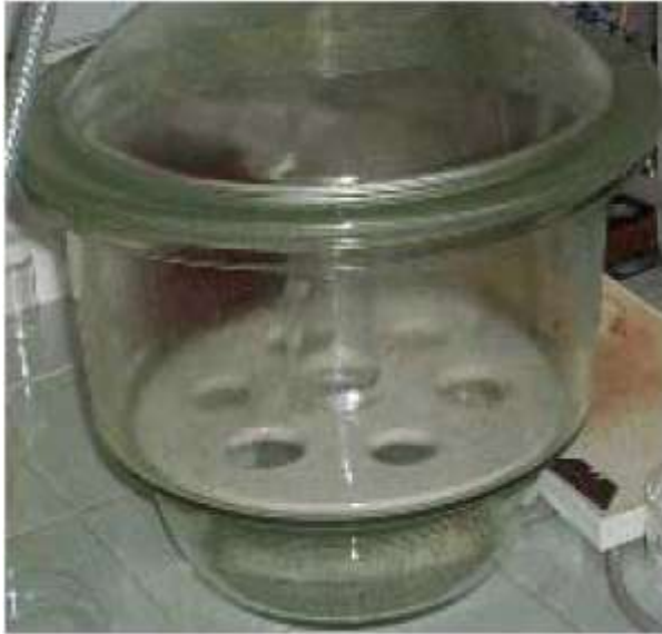
Εικόνα 5.2: Στον ξηραντήρα δημιουργείται κενό υπό πίεση με τη βοήθεια μηχανικής αντλίας με σκοπό να απομακρυνθούν οι φυσαλίδες από το πολυμερικό μίγμα.
