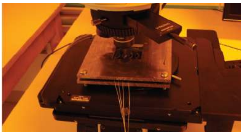
Εικόνα 5.8: Η κατασκευή αλουμινίου μαζί με τη μικρορευστομηχανική διάταξη και το διαμορφωμένο δισκίο, στο μικροσκόπιο Olympus MX61. Οι φωτογραφίες ελήφθησαν από ψυχόμενη φωτογραφική μηχανή, 12-bit και αναλύθηκαν μέσω 2-D μετασχηματισμού Fourier, για να απομονωθεί ο παράγοντας της αντίθεσης.
