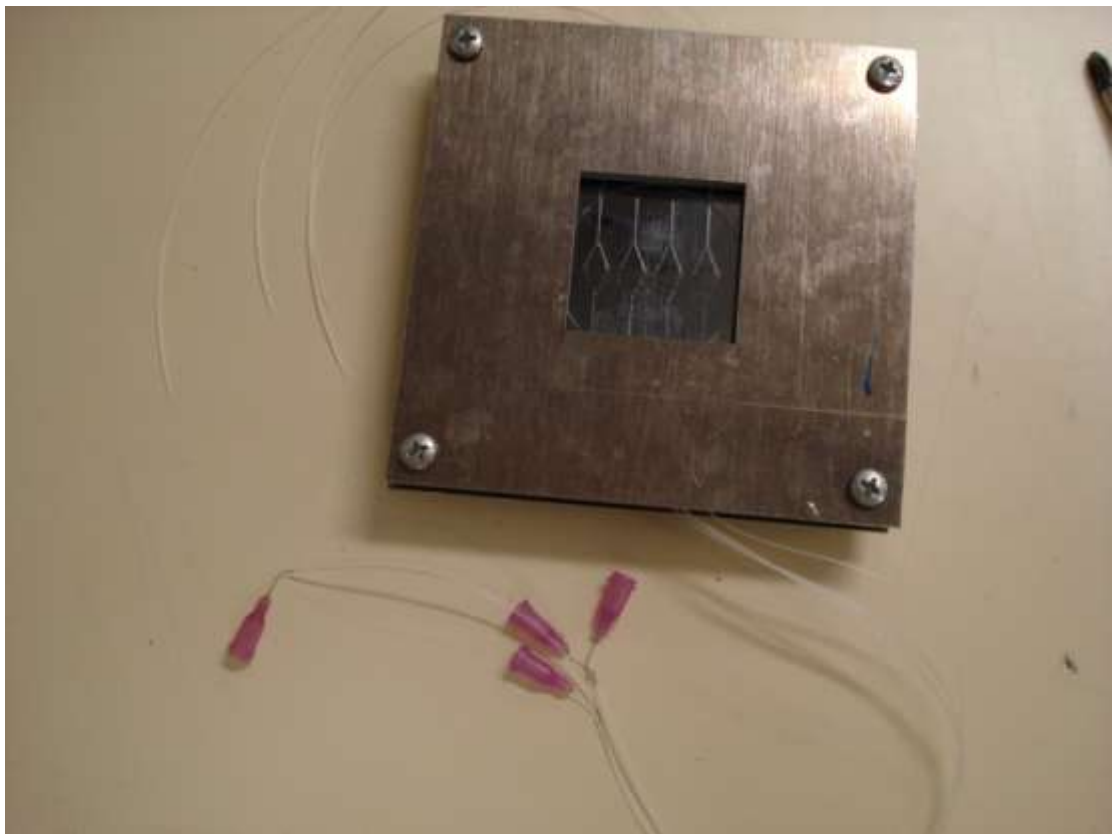
Εικόνα 5.7: Η πειραματική διάταξη. Στο εσωτερικό του μικρού τετραγώνου διακρίνεται το fluidic πάνω στο δισκίο. Επίσης φαίνονται και οι σωλήνες απ' όπου εγχέουμε τα αντιδραστήρια.
