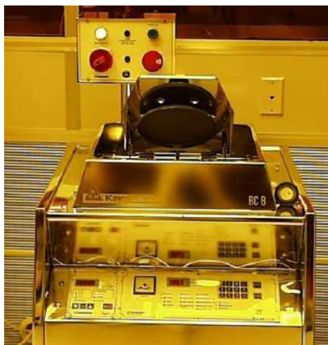
Εικόνα 5.3: Περιστροφικός επιστρωτής. Μοντέλο Karl Suss RC-8
