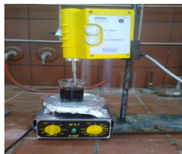
Σχήμα 4.3: Φωτογραφία της φυγόκεντρος (αριστερά) και της διάταξης επιβολής υπερήχων με ταυτόχρονη ανάδευση (δεξιά)
