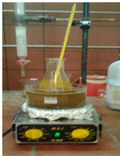
Σχήμα 4.1: Φωτογραφία του σταδίου ανάδευσης και θέρμανσης του μείγματος, κατόπιν προσθήκης υδατικού διαλύματος 5% H_2SO_4
