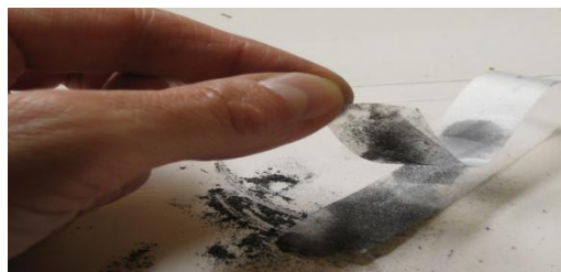
Σχήμα 1.10: Μηχανική αποφλοίωση γραφίτη (Scotch-tape method)
