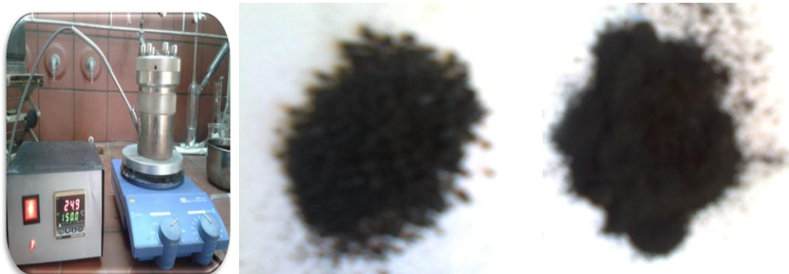
Σχήμα 4.4: Φωτογραφία του αυτόκλειστου με διάταξη θερμοστοιχείου για έλεγχο της θερμοκρασίας (αριστερά), του τελικού προϊόντος GO/Fe 3 O 4 NPs (μέση) και rGO/Fe 3 O 4 NPs (δεξιά)
