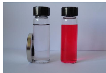
Σχήμα 3.12: Φωτογραφία του διαλύματος φουξίνης (δεξιά) και του διαλύματος μετά την προσρόφηση από GO/Fe 3 O 4 και τον μαγνητικό διαχωρισμό [73].
