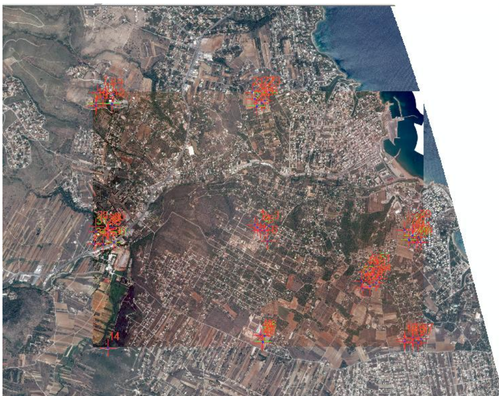
Εικόνα 4-13: Σημεία ελέγχου δορυφορικής εικόνας Pleiades και ορθοεικόνας ΟΚΧΕ
