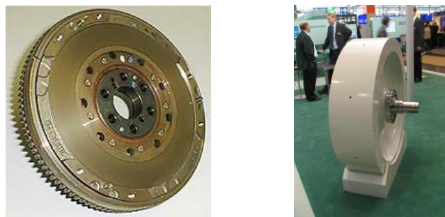
Εικόνα 33 Αριστερά σύγχρονο βολάν, χρησιμοποιούμενο στην αυτοκίνηση και δεξιά βολάν χρησιμοποιούμενο στη βιομηχανία.
