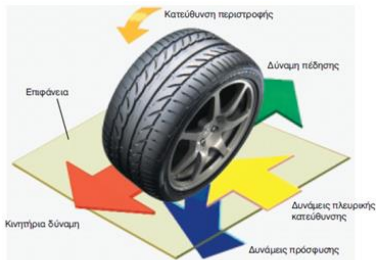
Εικόνα 9 Δυνάμεις που επενεργούν στον τροχό του οχήματος.
