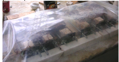
Εικόνα 112. Συντήρηση σύνθετων δοκιμών με νωπή λινάσσα και υδατοστεγανή μεμβράνη.
