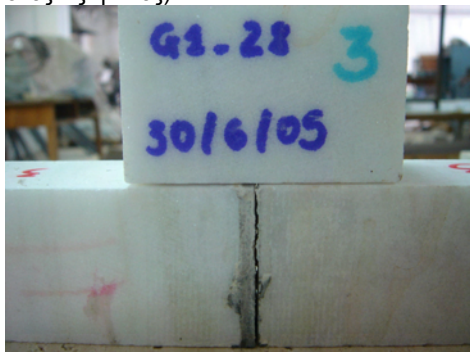
Εικόνα 152. Τυπική μορφή αστοχίας σε εφελκυσμό σύνθετων δοκιμίων μαρμάρου /ενέματος G1.
