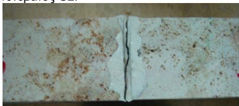
Εικόνα 154. Τυπική μορφή αστοχίας σε εφελκυσμό σύνθετων δοκιμίων τραβερτίνη /ενέματος G1 ή G4.
