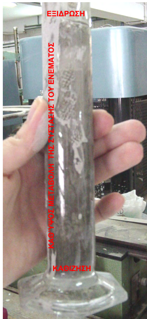
Εικόνα Β2. Απόμιξη ενέματος.
