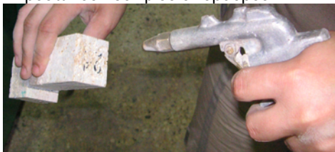
Εικόνα 108. Καθαρισμός «προσώπου» δοκιμίου υποβάθρου με πεπιεσμένο αέρα.
