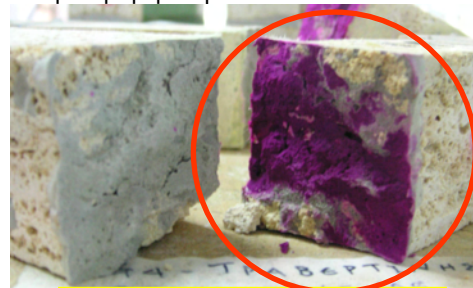
Εικόνα 163. Ρηγματώσεις στα σύνθετα δοκίμια τραβερτίνη/G4.
