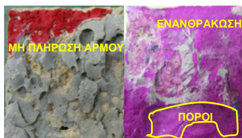
Εικόνα 143. Δοκιμές εφελκυσμού: Φωτογραφική απεικόνιση κριτηρίων απόρριψης δοκιμών (2α, 2β, 2γ).
