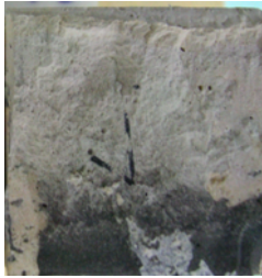
Εικόνα 158. Διατομή θραύσης σύνθετων δοκιμίων τραβερίνη/G1-Απόμιξη ενέματος.
