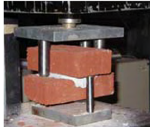
Εικόνα 49. Πειραματική διάταξη δοκιμής Cross Couplet κατά ASTM C952-02 (Gregoin et al. 2004).
