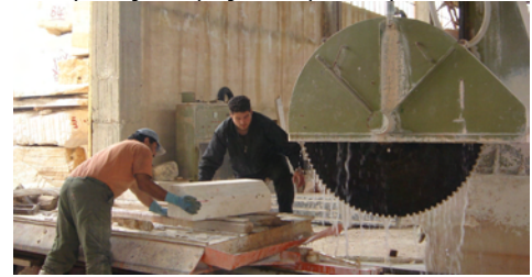
Εικόνα 101. Κοπή τεμαχίων υποβάθρων σε ειδικά κοπτήρια (ΦΑΣΗ 1).
