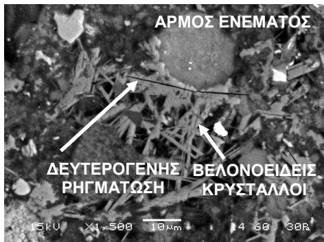
Εικόνα 136. Λήψη SEM: Ένεμα G2 σε υπόβαθρο τραβερίτη (90 ημέρες).
