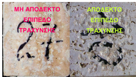
Εικόνα 142. Δοκιμές εφελκυσμού: Φωτογραφική απεικόνιση κριτηρίου απόρριψης δοκιμών (1).
