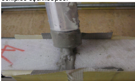
Εικόνα 110. Έγχυση ενέματος στον αρμό του σύνθετου δοκιμίου.
