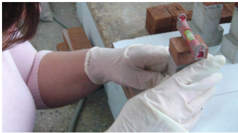
Εικόνα 105. Χρήση αεροστάθμης για την κατασκευή δοκιμίων υποβάθρων.
