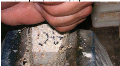
Εικόνα 107. Μηχανική τράχυνση «προσώπου» δοκιμίου υποβάθρου.
