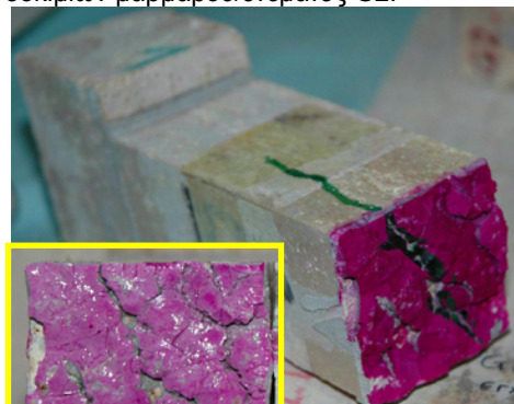
Εικόνα 161. Διατομή θραύσης σύνθετων δοκιμίων μαρμάρου/ενέματος G2.
