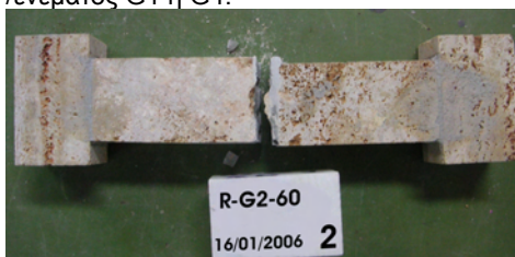
Εικόνα 155. Τυπική μορφή αστοχίας σε εφελκυσμό σύνθετων δοκιμίων τραβερτίνη /ενέματος G2.
