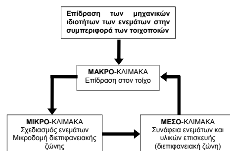
Εικόνα 88. Σχηματική απεικόνιση επίδρασης των ενεμάτων στην επισκευασμένη τοιχοποιία [βάσει της (Toumbakari 2002)].
