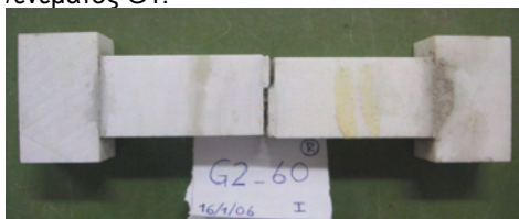
Εικόνα 153. Τυπική μορφή αστοχίας σε εφελκυσμό σύνθετων δοκιμίων μαρμάρου /ενέματος G2.
