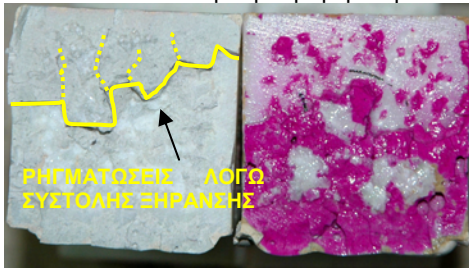
Εικόνα 161. Διατομή θραύσης σύνθετων δοκιμίων μαρμάρου/ενέματος G2.
