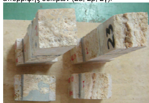
Εικόνα 143. Δοκιμές εφελκυσμού: Φωτογραφική απεικόνιση κριτηρίων απόρριψης δοκιμών (2α, 2β, 2γ).
