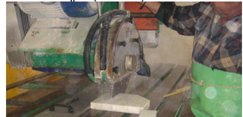
Εικόνα 102. Κοπή τεμαχίων υποβάθρων σε ειδικά κοπτήρια (ΦΑΣΗ 2).
