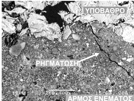
Εικόνα 127. Λήψη SEM: Ένεμα G2 σε οπτόπλινθου Α (90 ημέρες).
