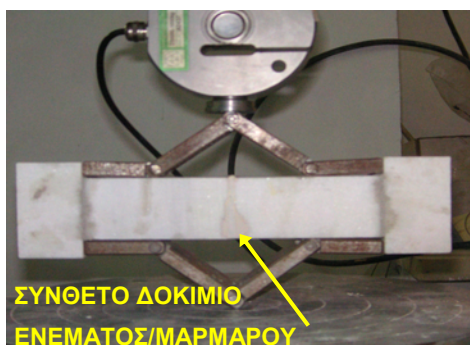
Εικόνα 119. Πειραματική διάταξη για τις δοκιμές άμεσου εφελκυσμού.
