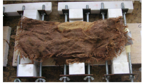
Εικόνα 111. Συντήρηση σύνθετων δοκιμών με νωπή λινάσσα.
