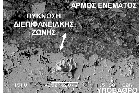
Εικόνα 132. Λήψη SEM: Ένεμα G4 σε υπόβαθρο τραβερίτη (90 ημέρες).
