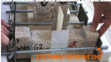
Εικόνα 109. Προετοιμασία σύνθετου δοκιμίου εφελκυσμού.
