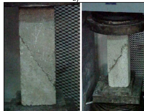
β) Εικόνα 59. α) Σχηματική απεικόνιση δοκιμής λοξής θλίψης (Wall et al 1988) σε β) σύνθετο δοκίμιο σκυροδέματος (Momayez et al 2004).
