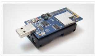
Εικόνα 27: Ο αισθητήρας CM5000, συμβατός με το IEEE 802.15.4 και με το πρότυπο TelosB [42]
