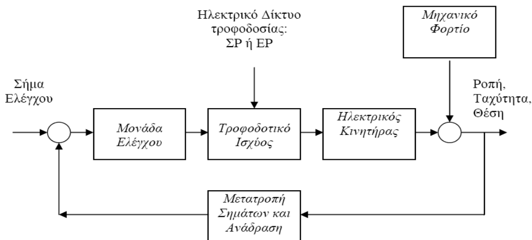
Εικόνα 3 Ελεγχόμενο Ηλεκτρικό Σύστημα
