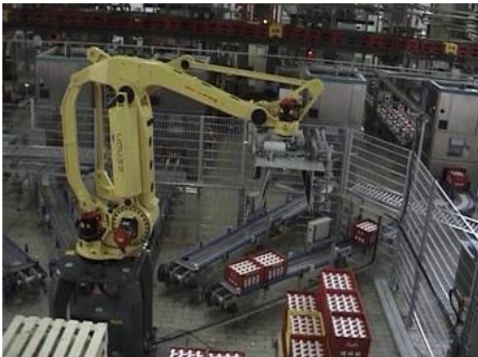
Εικόνα 1 Αυτοματοποίηση της γραμμής συσκευασίας σε βιομηχανία Ζυθοποιίας
