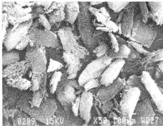
Σχήμα 2.8 Ηλεκτρονική μικρογραφία σάρωσης από wood flour πεύκου.
