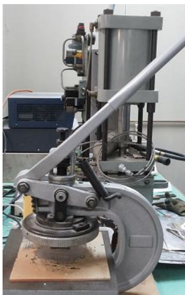
Σχήμα 4.16 Κοπτικό μηχανήμα παρασκευής δοκιμίων εφελκυσμού.
