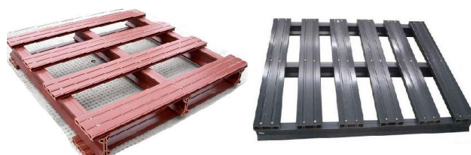
Σχήμα 2.17 Παλέτες μεταφοράς από WPC (60% wood flour, 30-35% Grade A HDPE, 5-10% πρόσθετα).
