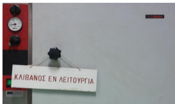
Σχήμα 3.4 Ο κλίβανος της γερμανικής εταιρίας “WTB Binder Labortechnik GmbH” που χρησιμοποιήθηκε για την ξήρανση των υλικών.
