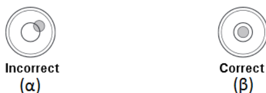
Σχήμα 3.6 Φουσαλίδα ελέγχου οριζοντίου επιπέδου του ζυγού Precisa. (α) Λάθος και (β) σωστή τοποθέτηση αντίστοιχα.
