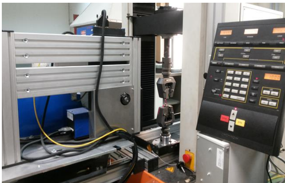
Σχήμα 4.18 Πειραματική διάταξη για τις δοκιμές εφελκυσμού (INSTRON 1121).
