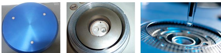
Σχήμα 4.5 Θερμαινόμενοι υποδοχείς, τοποθέτηση του δείγματος.
