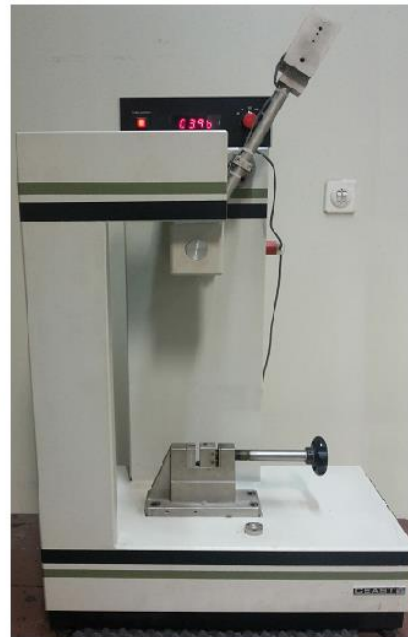
Σχήμα 4.29 Η πειραματική διάταξη “CEAST Universal Pendulums 6545/000”. (α) Περιγραφή βασικών στοιχείων. (β) Πραγματική εικόνα της διάταξης. Η σφύρα βρίσκεται στην θέση αναμονής και στην οθόνη αναγράφεται η μέτρηση από την τελευταία δοκιμή.
