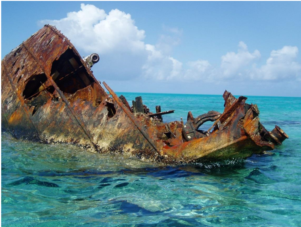
Εικόνα 1.2 Ναυάγιο πλοίου σε ύφαλο στη Χαβάη που έχει υποστεί διάβρωση [11]
