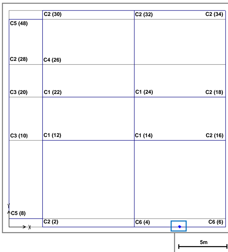
Σχήμα 79. Προσδιορισμός κέντρων δυσκαμψίας (α) ισόγειου και (β) ορόφου
