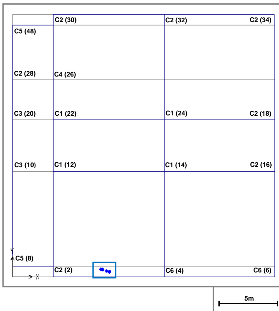
Σχήμα 78. (α) Καμπύλη ικανότητας φορέα με έκκεντρα τοιχώματα. Προσδιορισμός των κέντρων στροφής των διαφραγμάτων του (β) ισόγειου και του (γ) ορόφου, για τα βήματα που αναγράφονται στην καμπύλη.
