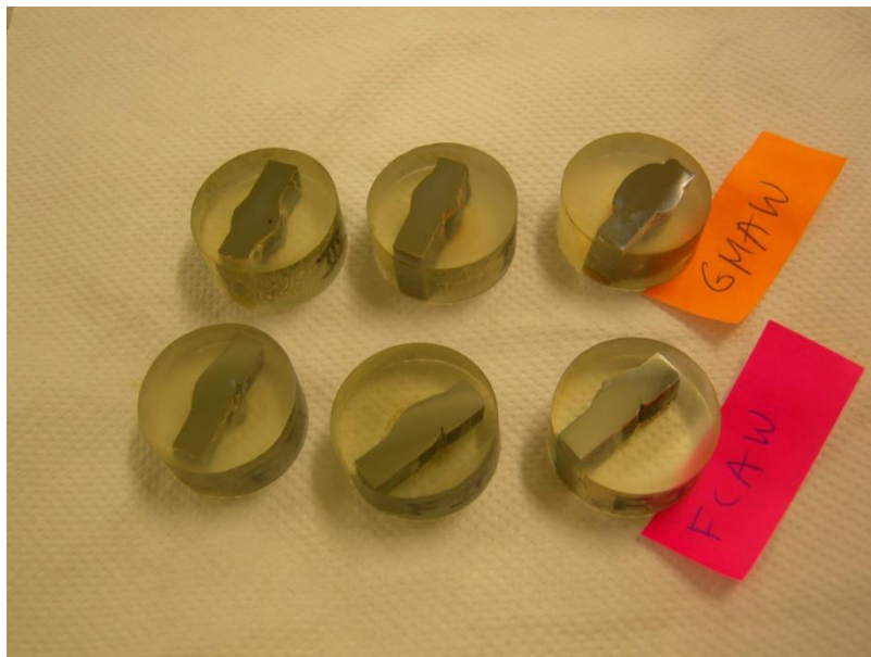
Εικόνα 21 : Τα εγκιβωτισμένα δοκίμια μετά τη λείανση και τη στίλβωση
