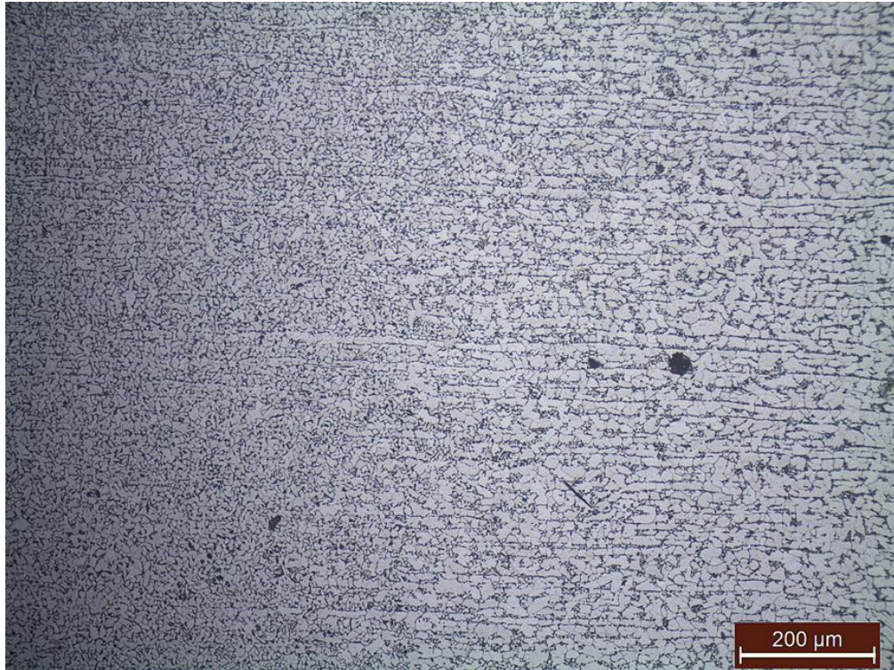
Εικόνα 29: Μεταλλογραφία στο όριο MB - ΘΕΖ στη συγκόλληση FCAW
