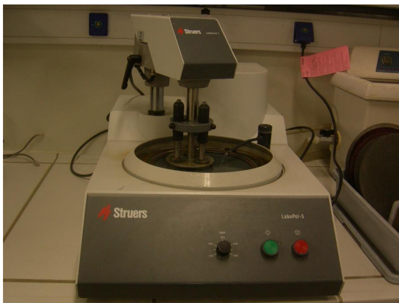
Εικόνα 20 : Η διαδικασία της λείανσης με το λειαντικό τροχό LoboPol-5 της Struers
