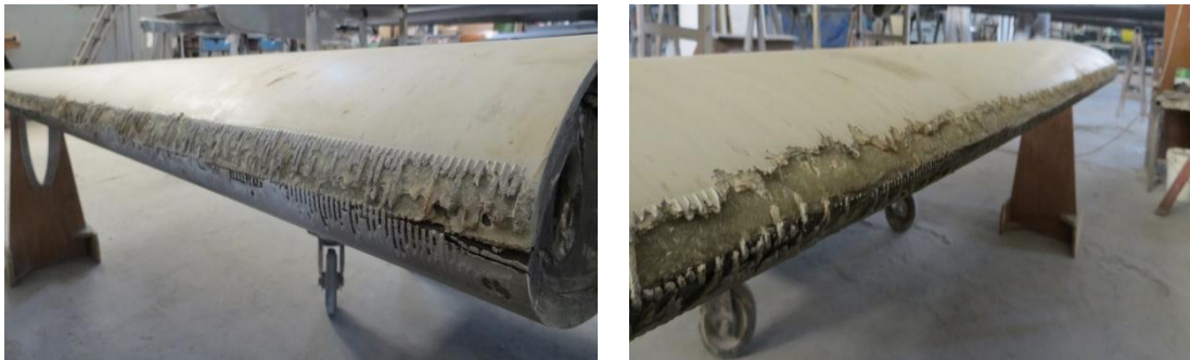
Σχήμα 1.1: Κατεστραμμένο άκρο ακμής πρόσπτωσης [5].
