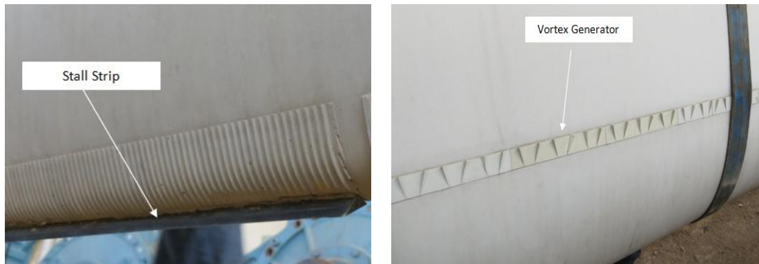
Σχήμα 1.2: Λεπτομέρεια της ακμής πρόσπτωσης του πτερυγίου της Α/Γ με εμφανή την ταινία αποκόλλησης (αριστερά) και της πλευράς υποπίεσης με τις στροβιλογεννήτριες (δεξιά) [5].
