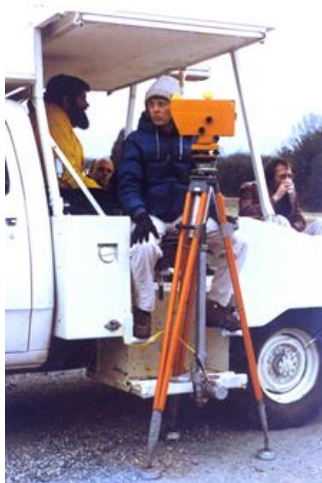
Εικόνα 54 : Το σύστημα Α.Τ.Υ. της Εθνικής Γεωδαιτικής Υπηρεσίας των ΗΠΑ
