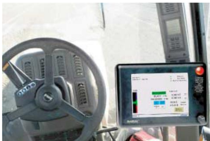
Εικόνα 46 : Η Οθόνη Αφής στο Αμάξι-Τρακτέρ
