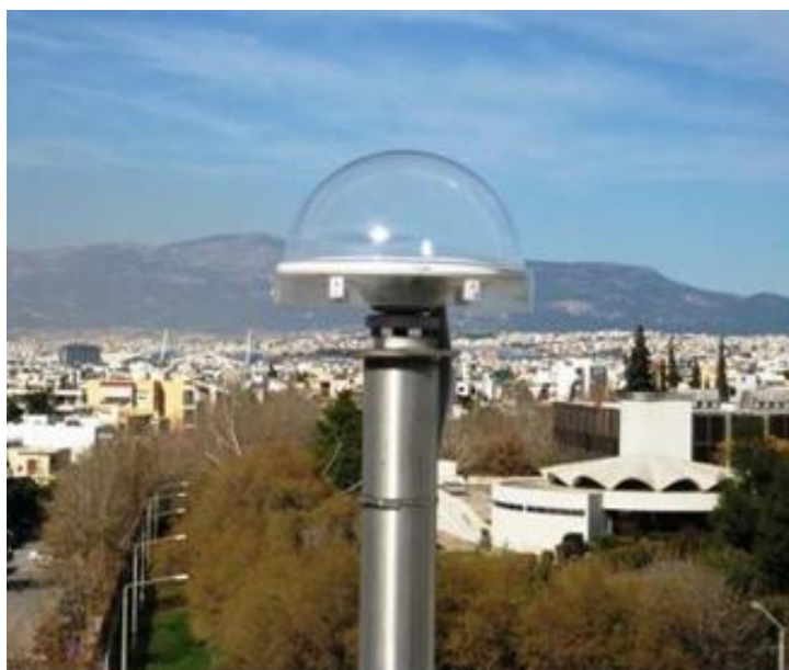
Εικόνα 26 : Ο Θόλος Σταθμού HEPOS
