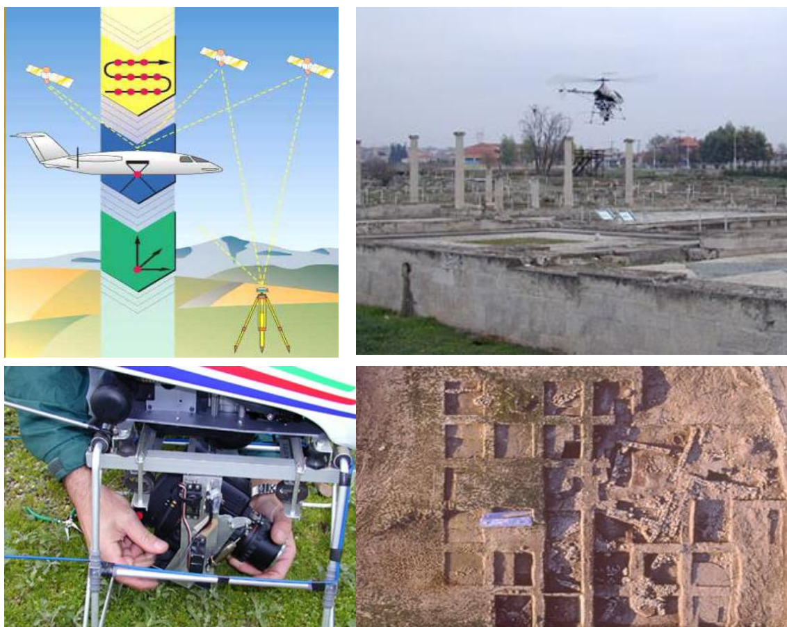
Εικόνα 50 : Κινηματικός Σχετικός Εντοπισμός σε Πτήση Λήψης Αεροφωτογραφιών
