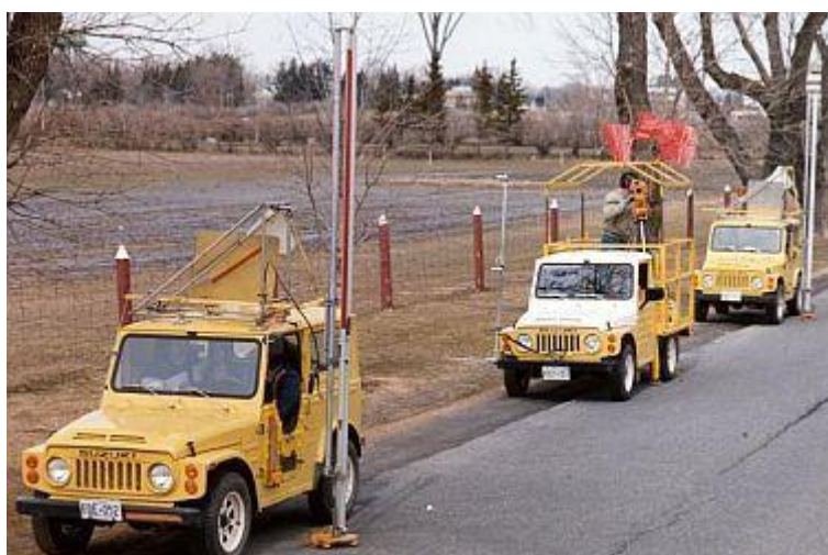
Εικόνα 53 : Το σύστημα A.T.Y. της Καναδικής Χαρτογραφικής Υπηρεσίας
