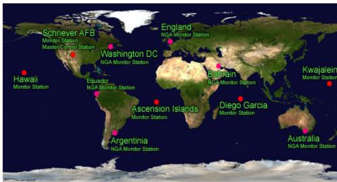
Εικόνα 4 : Επίγειο Τμήμα GPS
