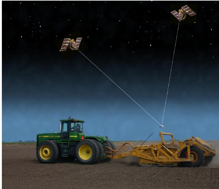
Εικόνα 45 : Σύστημα Οριζοντίωσης Εδάφους AutoLevel
