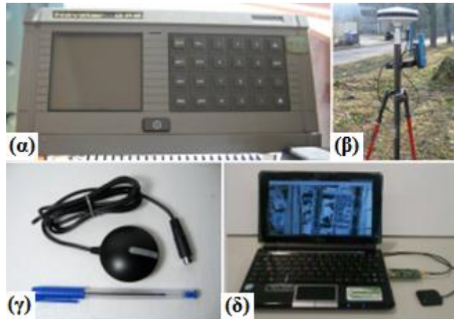
Σχήμα 1.23 : Διαφορετικοί τύποι δεκτών GNSS: (α) Θαλάσσιος (β) Γεωδαιτικός (γ) Οχήματος (δ) Λογισμικού
