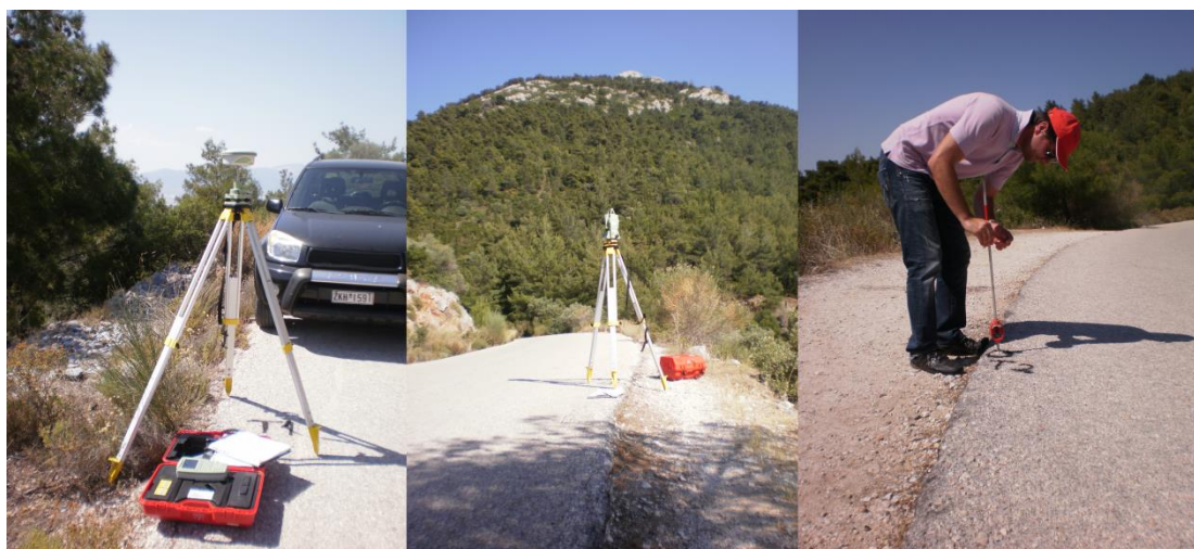
Σχήμα 5.1 : Εργασίες Υπαίθρου - Μέτρηση Όδευσης
