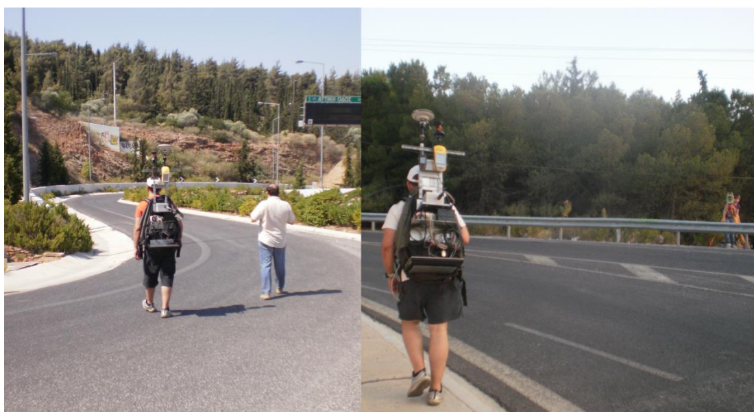
Σχήμα 5.2 : Μετρήσεις με το σύστημα καταγραφής και γεωδαιτικό σταθμό
