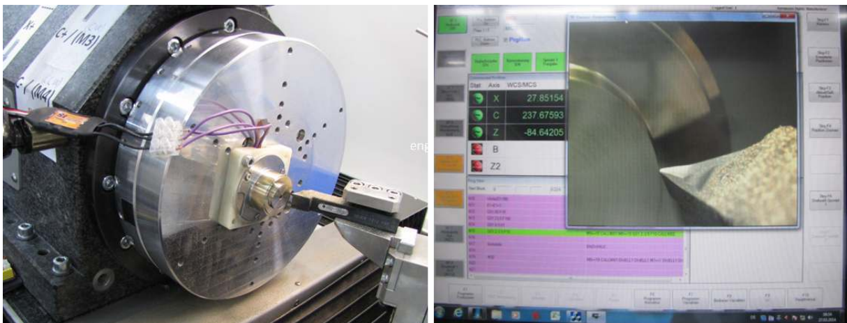
Abbildung 53, Feinbearbeitung des Schleifscheibenhalters
