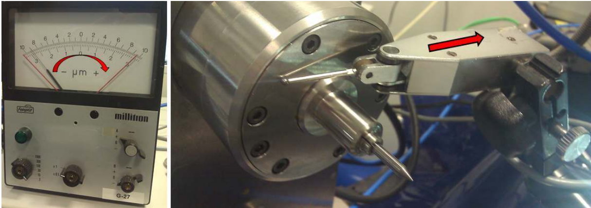
Abbildung 87, Messung der Parallelität
