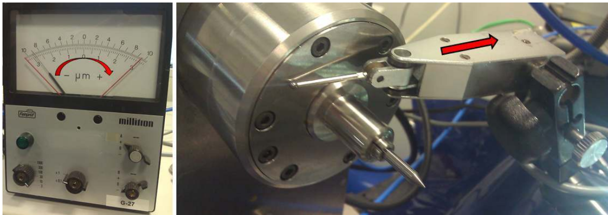
Εικόνα 85, μέτρηση της παραλληλίας
