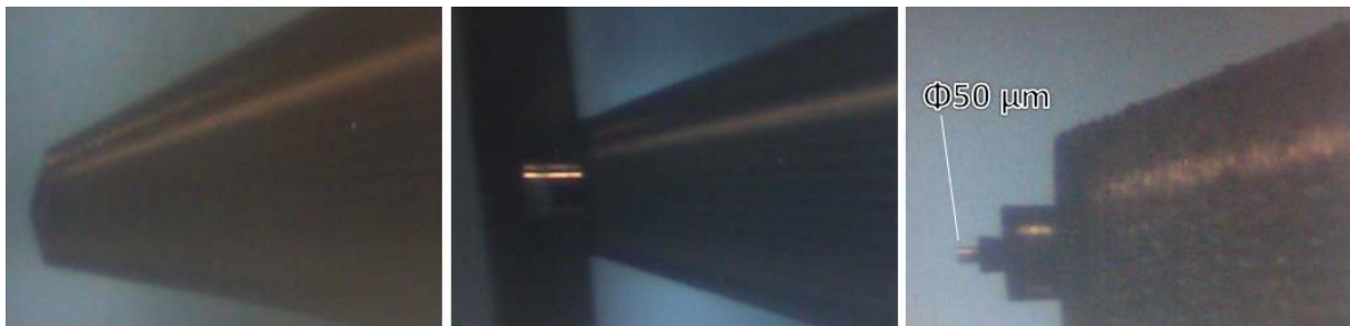
Abbildung 94, Erzeugtes Mikrowerkzeug mit Durchmesser 50\mu\text{m}
