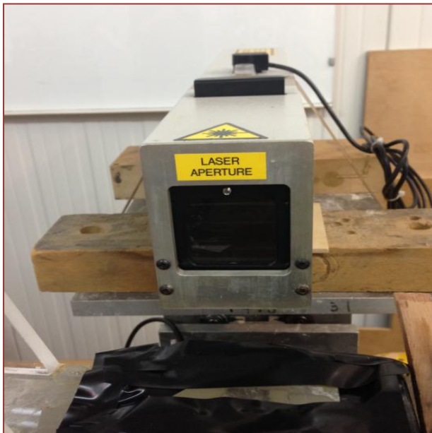
3-9 Μπροστινή και πλάγια όψη laser της Oxford Lasers, μήκους κύματος 808 nm .
