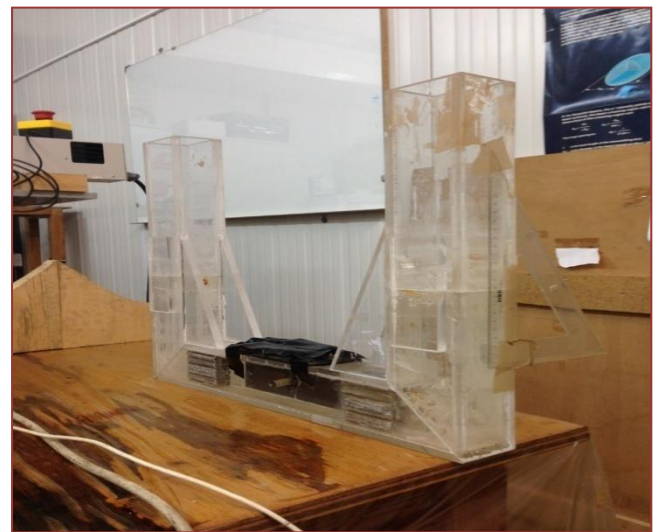
3-4 Μπροστινή και πλάγια όψη του δοχείου νερού, σχήματος αναστραμμένου-Π.
