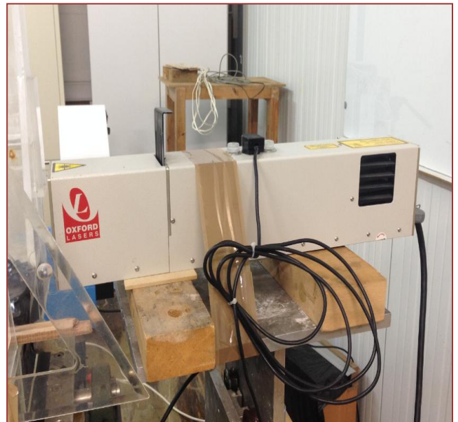
3-9 Μπροστινή και πλάγια όψη laser της Oxford Lasers, μήκους κύματος 808 nm .
