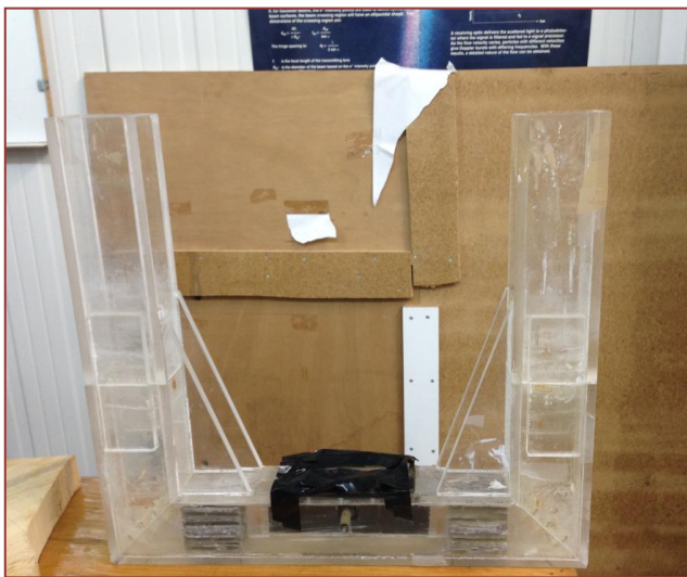
3-4 Μπροστινή και πλάγια όψη του δοχείου νερού, σχήματος αναστραμμένου-Π.
