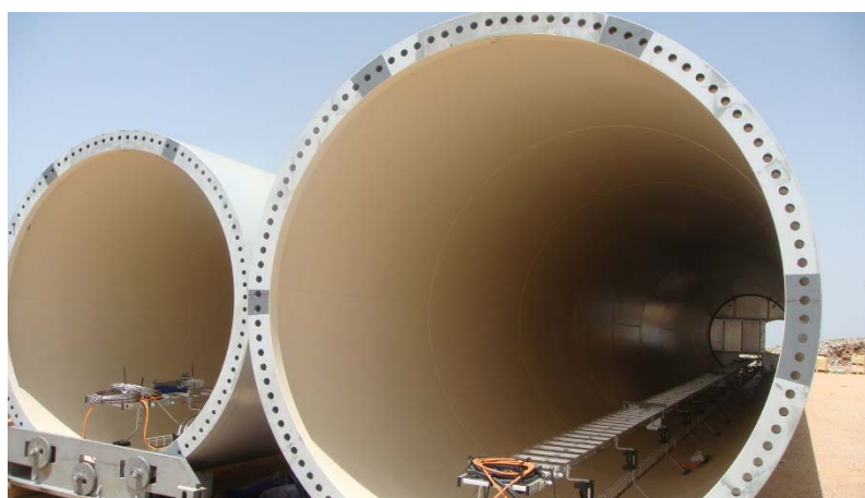
Σχήμα 3-4: Δακτυλιοειδή πέλματα σύνδεσης αποκατάστασης συνέχειας πυλώνα ανεμογεννήτριας
